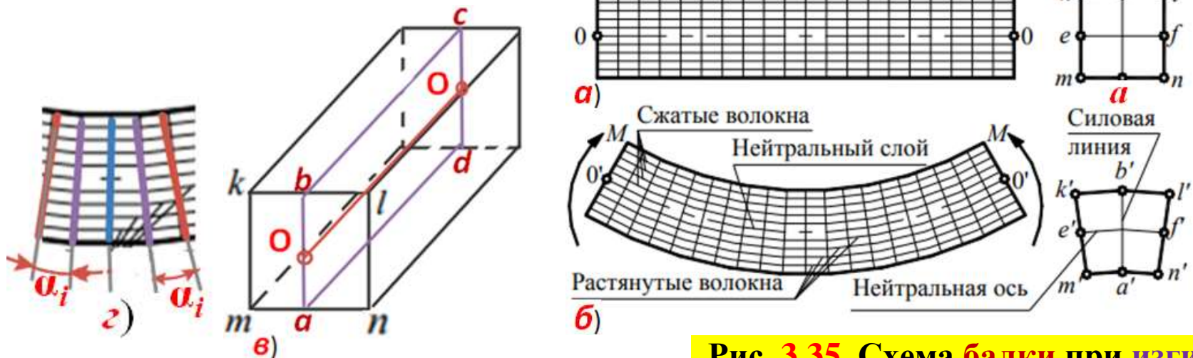
Рис. 3.36. При сжатии уменьшение продольного размера приводит к увеличению поперечного размера (действует даже при упругой деформации)
