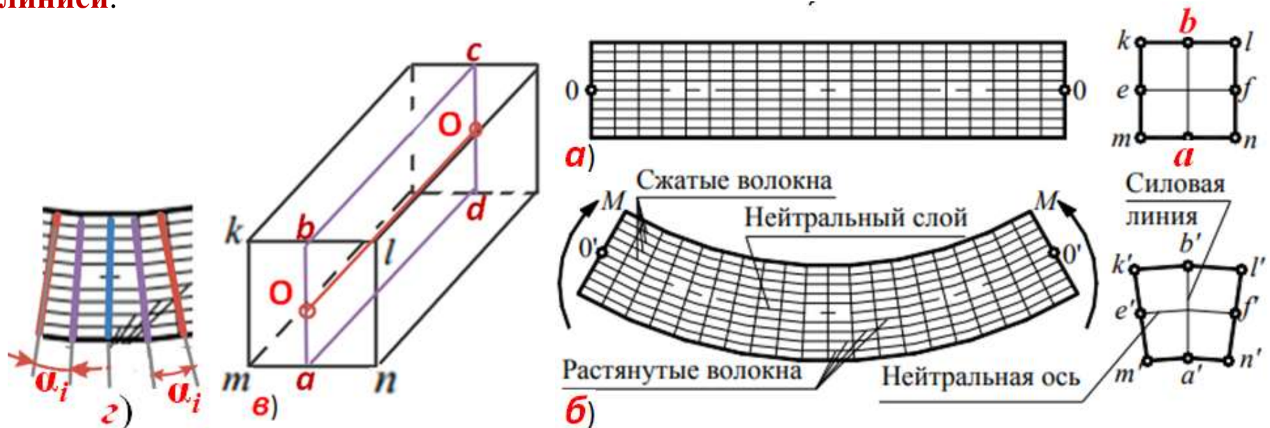
Рис. 3.35. Схема балки при изгибе
