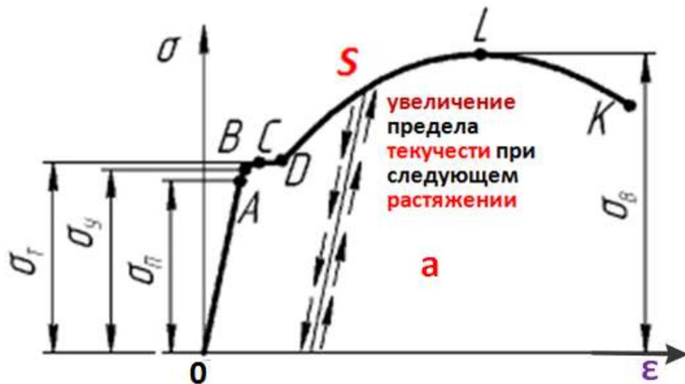
Рис. 3.22. Напряжения при повторных осевых растяжениях
