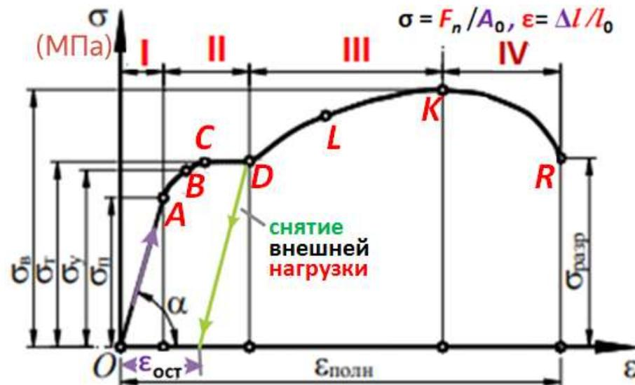
Рис. 3.13. Условная диаграмма растяжения пластичного образца
