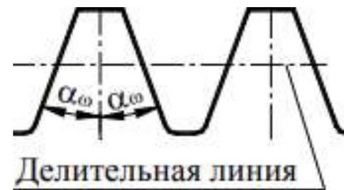
Рис. 4.87. **Трапецидальный** зуб при  $r_{\omega 1} \rightarrow \infty$  и  $r_{b1} \rightarrow \infty$
