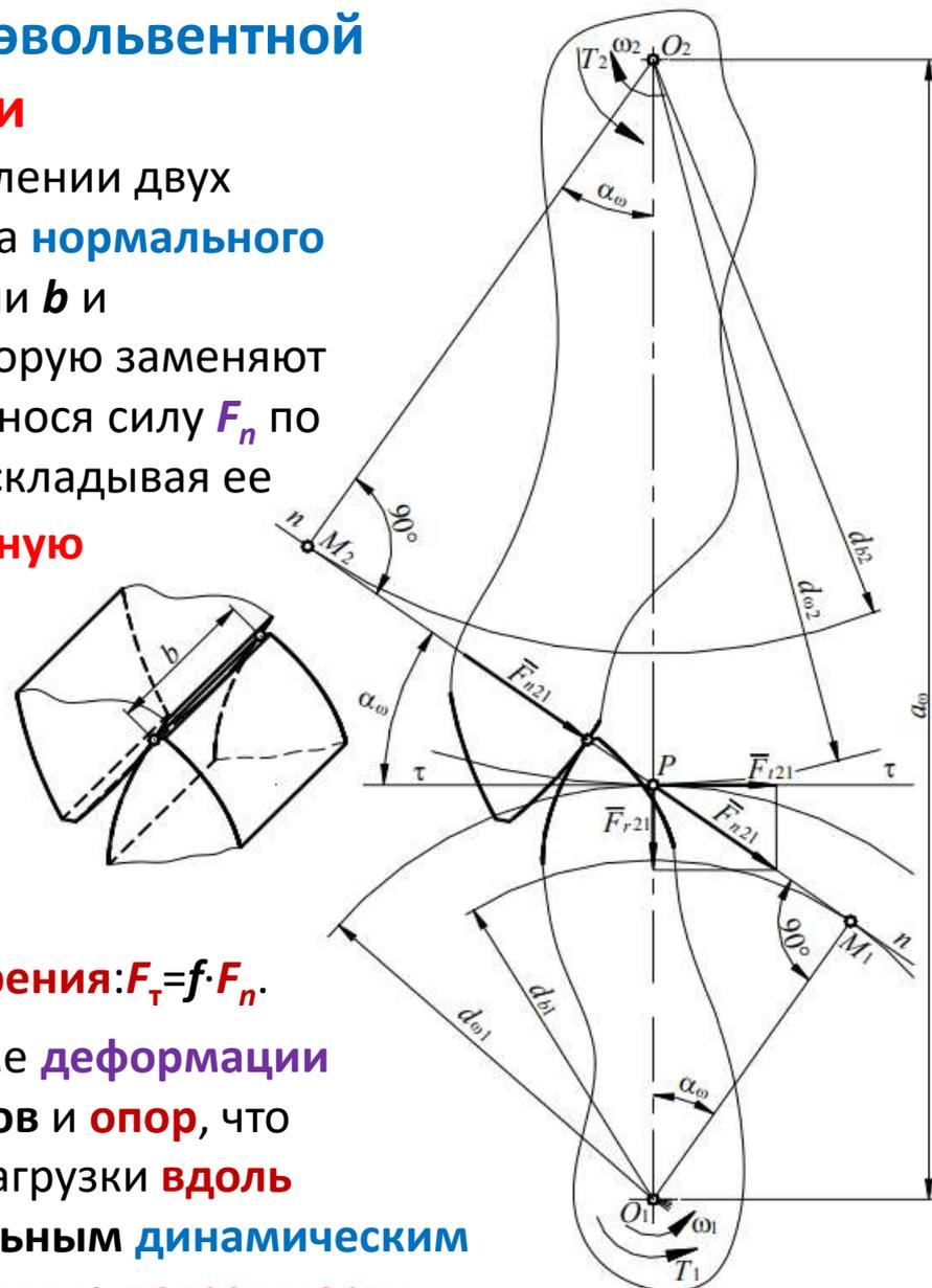
Рис. 4.101. Схема сил, действующих на зуб
