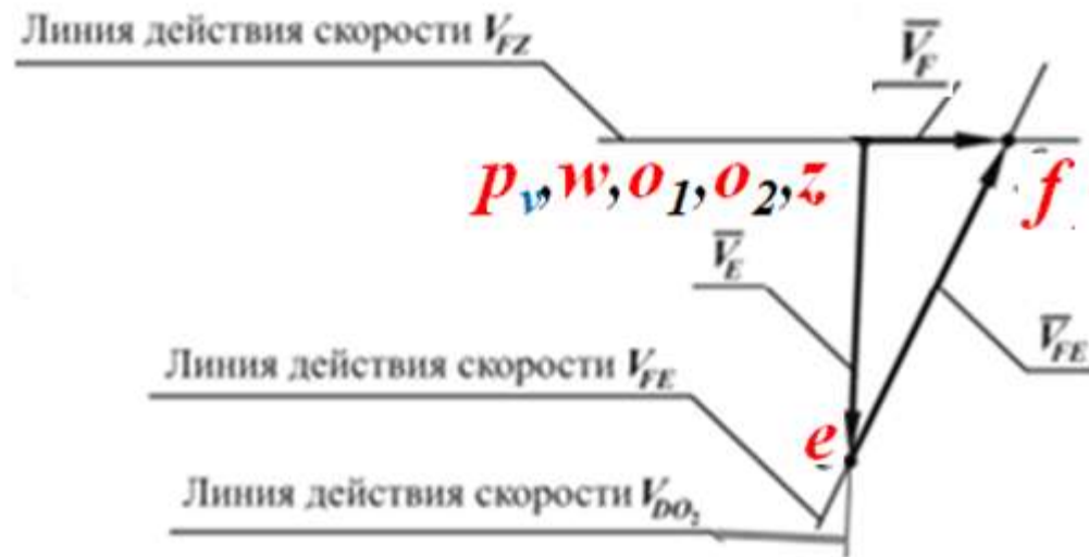
Рис. 2 б. План скоростей нижней части крупно (Пример)
