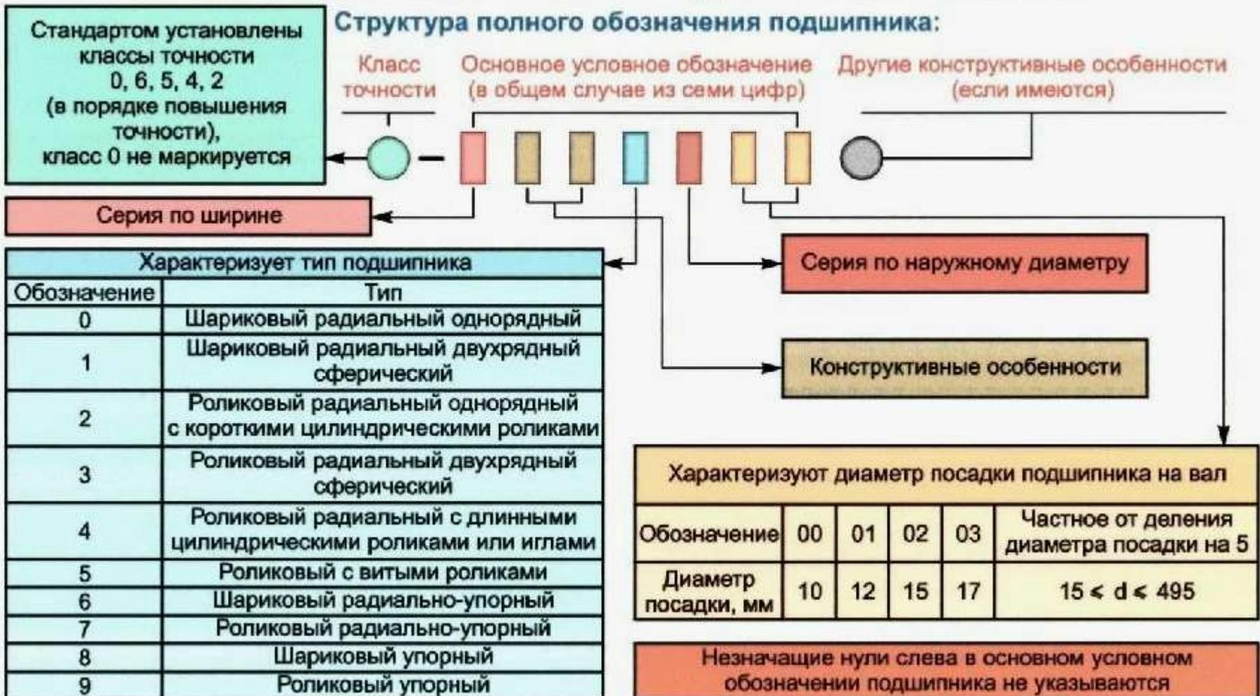
Рис. 4.74. Условное обозначение подшипников качения
