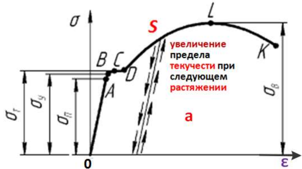
Рис. 3.22. Напряжения при повторных осевых растяжениях
