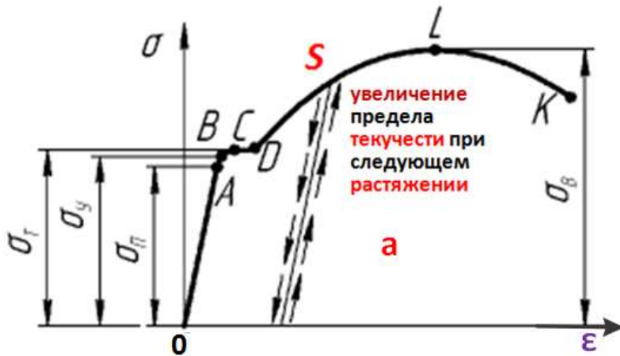
Рис. 3.16. Напряжения при осевом растяжении пластичной малоуглеродистой стали (а) и сравнение влияния пластичности на вид диаграммы (б)
