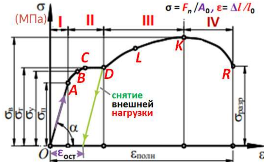
Рис. 3.13. Условная диаграмма растяжения пластичного образца
