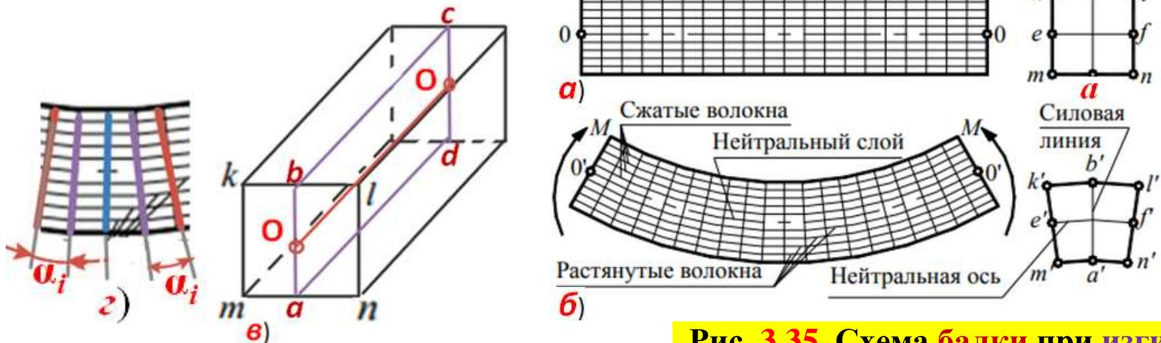
Рис. 3.35. Схема балки при изгибе
