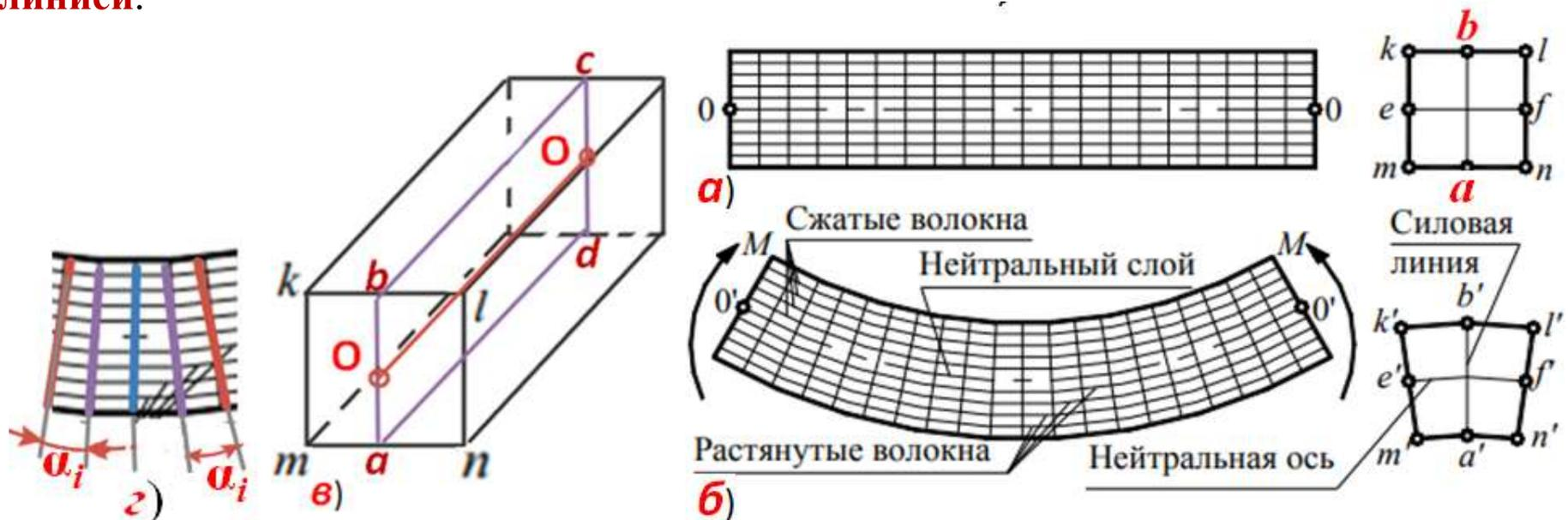
Рис. 3.35. Схема балки при изгибе
