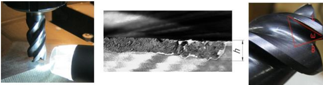
Рис. 4. Измерение величины фаски износа h на задней поверхности портативным микроскопом мод. 50-500х фирмы Kromatech (КНР)
