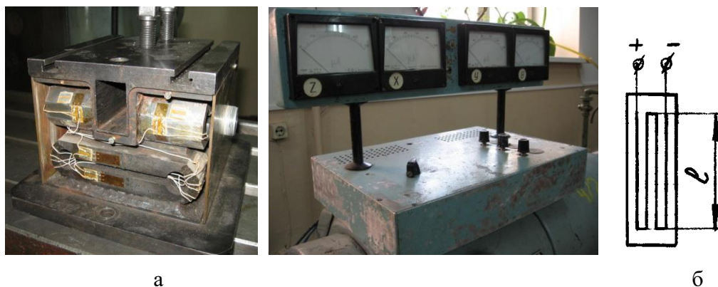
Рис.1.2. Трёх компонентный токарный динамометр конструкции В.Н. Сбоева и В.В. Брюхова (а),
