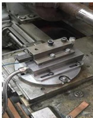
Рис. 10. Установка резца в динамометр Kistler на токарном станке
