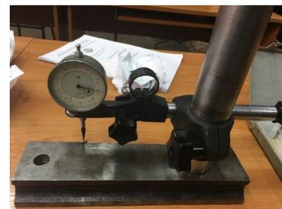
Рис. 14. Прибор для измерения усадки стружки
