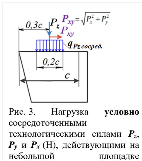
Рис. 3. Нагрузка **условно** сосредоточенными технологическими силами  $P_z$ ,  $P_y$  и  $P_x$  (Н), действующими на небольшой площадке
