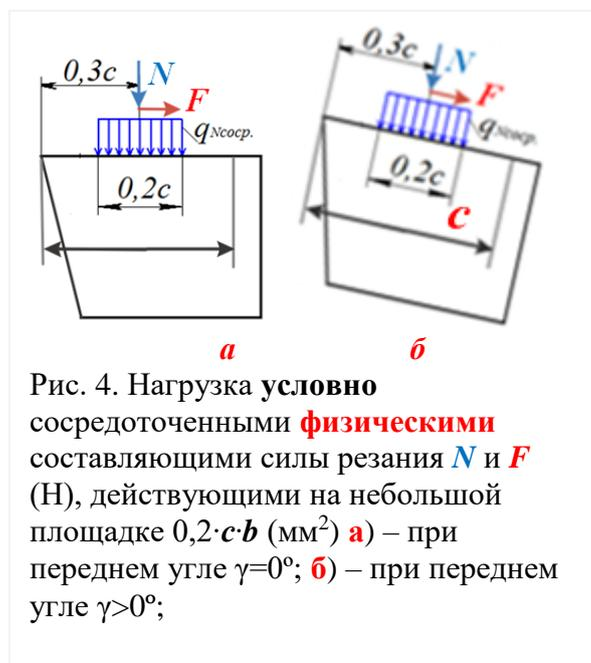
Рис. 4. Нагрузка **условно** сосредоточенными **физическими** составляющими силы резания  $N$  и  $F$  (Н), действующими на небольшой площадке  $0,2 \cdot c \cdot b$  (мм<sup>2</sup>) **а** – при переднем угле  $\gamma = 0^\circ$ ; **б** – при переднем угле  $\gamma > 0^\circ$ ;
