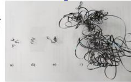
Рис. 21. Типы стружки: а) полукольца; б) нормальная; в) допустимая форма; г) недопустимая форма
