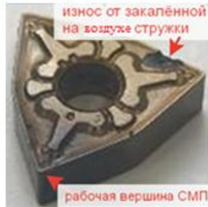
Рис. 20. СМП-WNMG080404 с покрытием TiN с износом на нерабочей кромке ( v = 360 м/мин)
