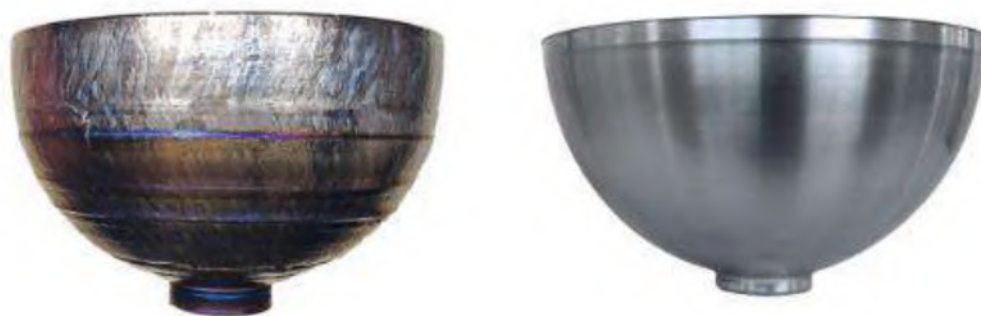
Рис.2. Полусфера, выращенная при использовании аддитивных технологий и после механической обработки.
