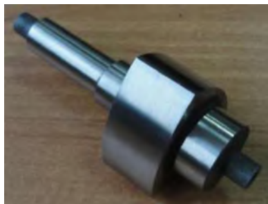
Рисунок 3 – Деталь в форме РК-профиля, полученная методом фрезоточения.
