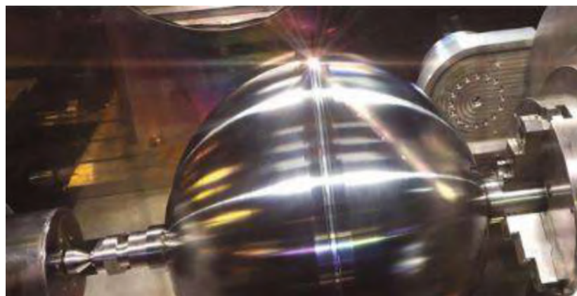
Рис.1 Шар-баллон изготовленный в АО «РКЦ «Прогресс» [1].
