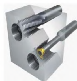
Рис. 3. Нарезание внутренней резьбы фрезой и резьбовым резцом
