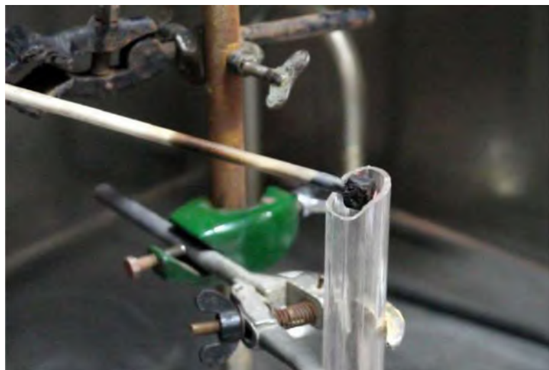
Рис. 1. Исследовательская платформа по измерению времени горения образца. Модуль размещения и сжигания образца.
