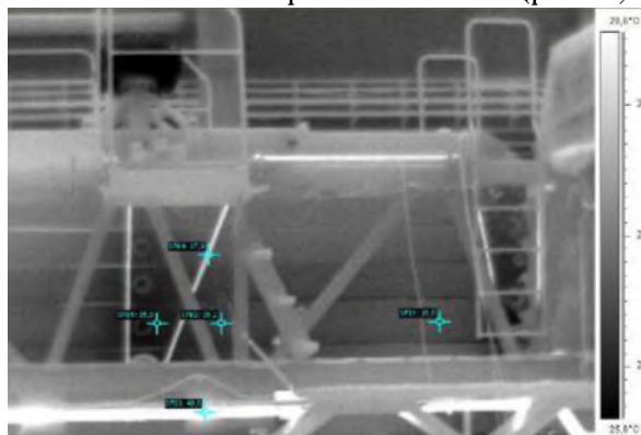
Рис. 1. Термограмма испытаний подъемника, начало подъема.
