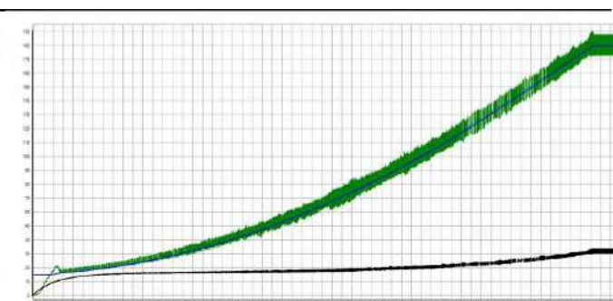
Рис 2. Переходные процессы тока и момента двигателя при t_{ин} = 56 сек.
