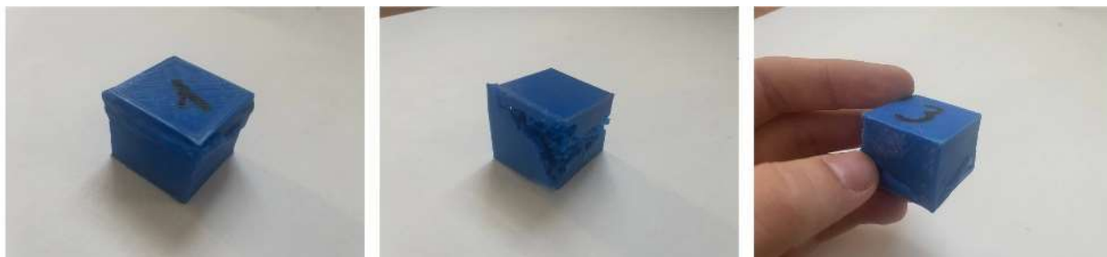
Рис. 4. Кубики из PETG пластика после проведения испытаний
