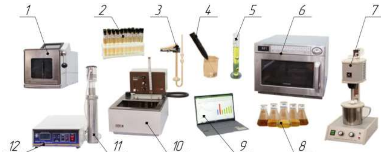
Рис. 1. Экспериментальная установка для исследования вязкости и плотности дизельного топлива, МЭРМ и смесового биотоплива различных концентраций:
