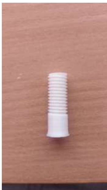
Рис. 2. Резьба, полученная из модели, выполненной в КОМПАС
