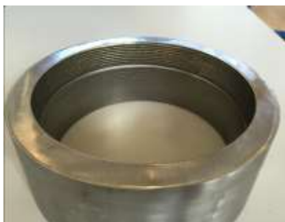
Рис. 1. Накладка облицовки в трубе с помощью Инконель 625
