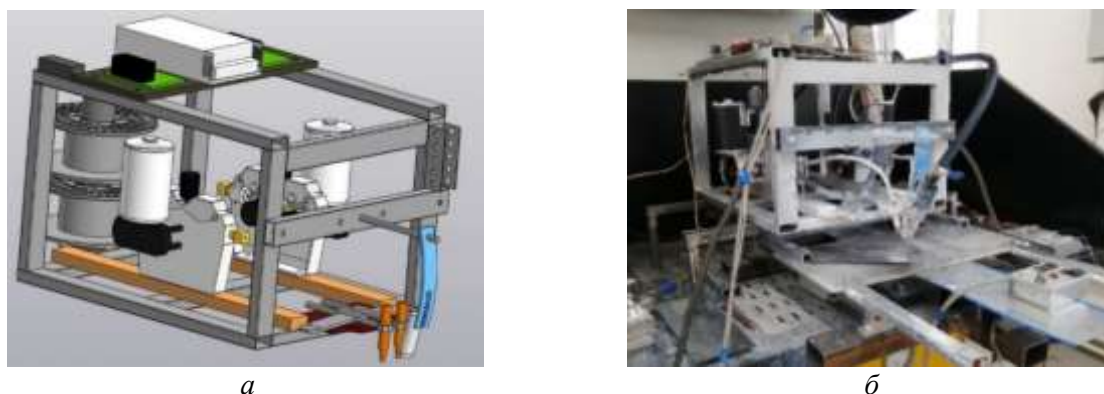
Рис. 1. Установка для проведения исследований: а – модель, б – лабораторный образец
