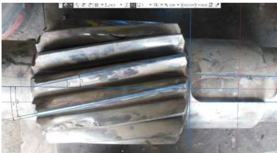
Рис. 3. Схема выполнения измерений методом обмера (обкатки) с помощью CAD-системы и фотографии
