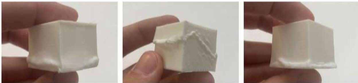
Рис. 2. Кубики из PLA пластика после проведения испытаний
