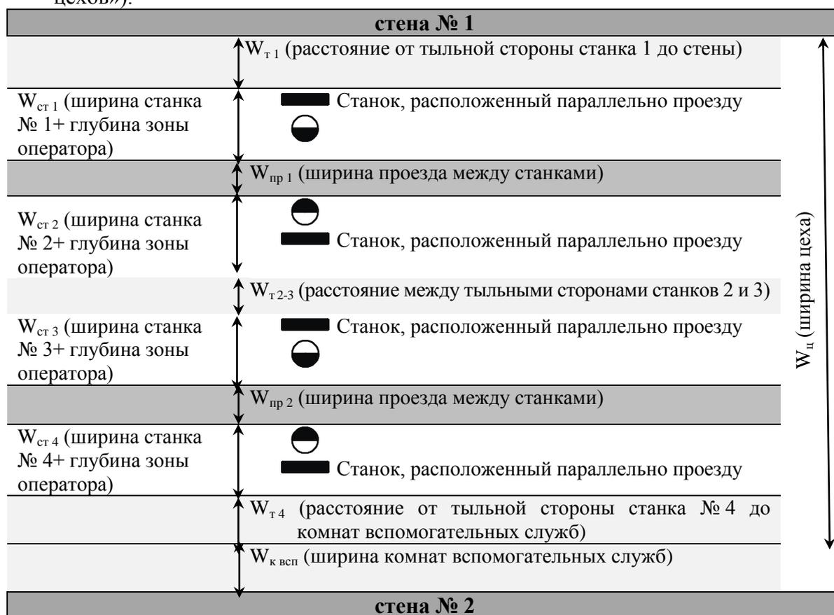
Рис. 1. Схема расположения станков с двумя проездами и с четырьмя рядами станков
