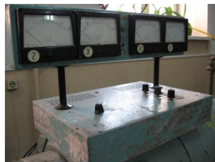
Рис. 2.22. Усилитель с регистрирующими приборами (микроамперметрами) по четырём каналам
