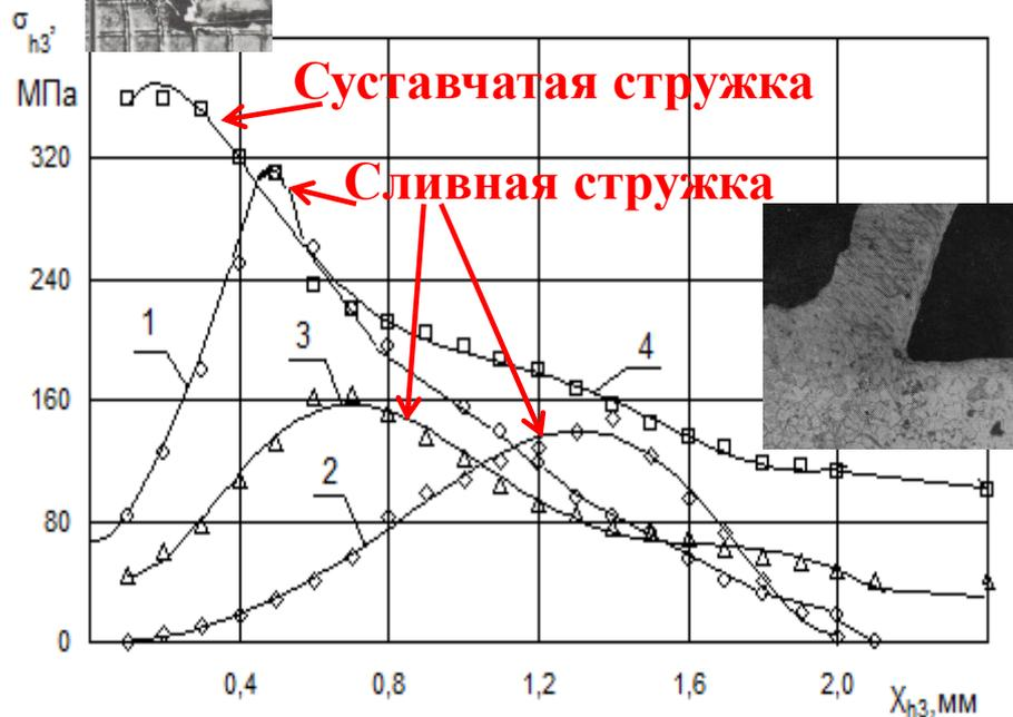
а) распределение нормальных  $\sigma_h$  и касательных  $\tau_h$  контактных напряжений на фаске задней поверхности инструмента при сливном стружкообразовании. ЛБЗ-Р6М5,  $\gamma=0^\circ$ ,  $\alpha_\phi=0^\circ$ : 1 -  $S=0,06$  мм/об,  $V=100$  м/мин; 2 -  $S=0,21$  мм/об,  $V=100$  м/мин; 3 -  $S=0,21$  мм/об,  $V=217$  м/мин.
