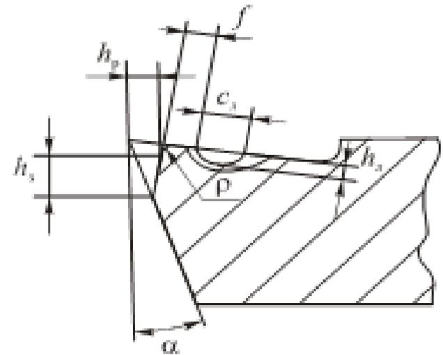
износ в зоне контакта с необработанной поверхностью
