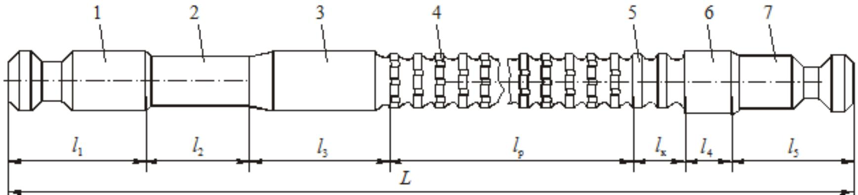
Конструктивные элементы протяжки для обработки отверстий: **1 – хвостовик;**
