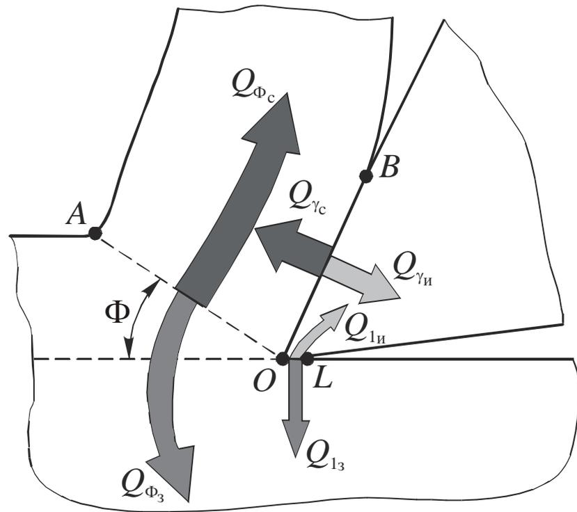
Потоки теплоты, отводимой в стружку, заготовку и инструмент
