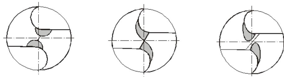
3) **заточка под двойными углами при вершине сверла.** При этом  $2\varphi = 116^\circ$ , а  $2\varphi_1 = 70...90^\circ$ , с шириной дополнительной заточки по уголкам  $b = (0,1...0,2)d$ . Уменьшается износ наиболее уязвимых периферийных участков режущих кромок сверла, где скорость резания наибольшая, а передние углы меньше на  $7...8^\circ$ .
