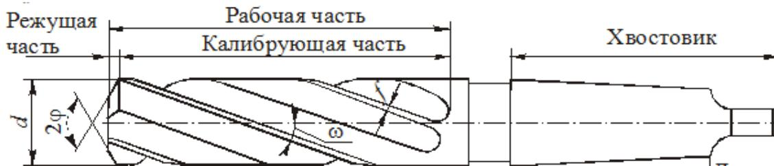
Цилиндрический хвостовой зенкер с коническим хвостовиком
