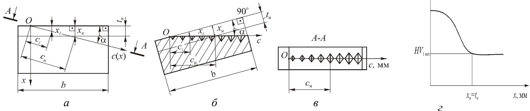
Исследование глубины и степени наклёпа: *a* – выполнение косого шлифа под углом  $\alpha$  к поверхности заготовки; *б* – положение контролируемой поверхности при измерении её микротвёрдости; *в* – размеры отпечатков при измерении микротвёрдости; *г* – изменение микротвёрдости по глубине.
