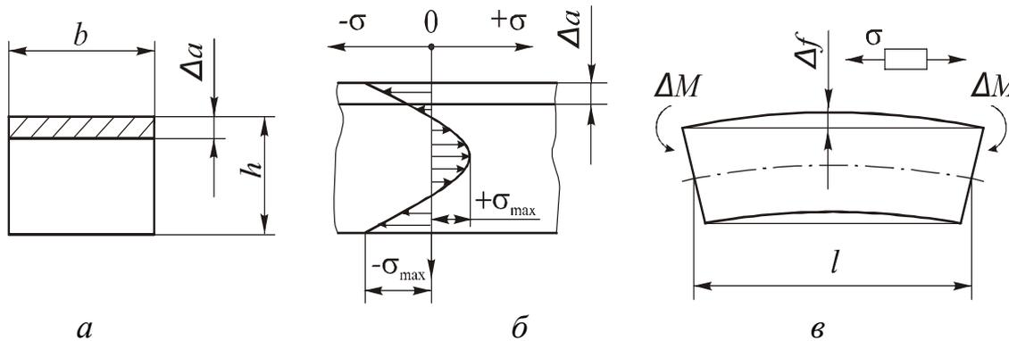
Рис. 1. Определение остаточных напряжений в заготовке механическим путём: *a* – удаление слоя металла толщиной  $\Delta a$ ; *б* – пример распределения остаточных напряжений в заготовке; *в* – изгиб пластины после удаление слоя металла толщиной  $\Delta a$  от перераспределения остаточных напряжений отпечатков при измерении микротвёрдости; *г* – изменение микротвёрдости по глубине.
