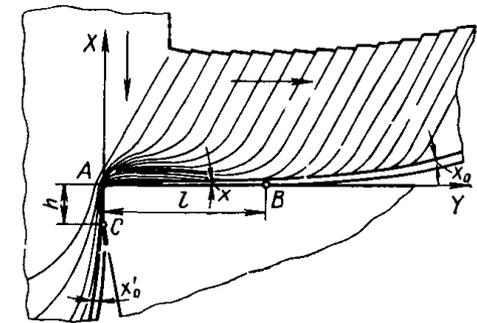
Рис. 1. Образование зоны вторичной пластической деформации (точение)
