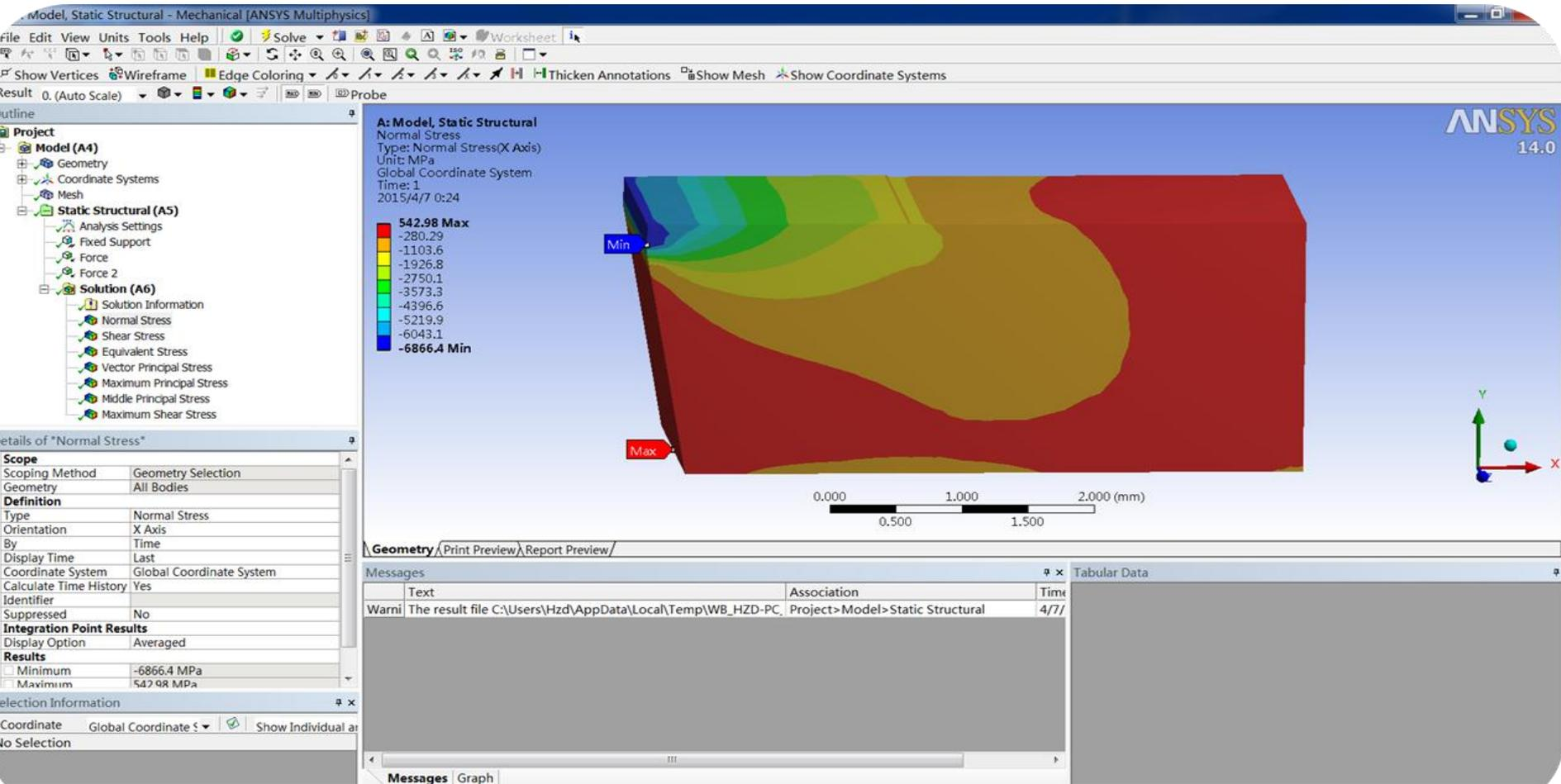
Результаты расчёта распределения внутренних напряжений в режущем клине резца методом конечных элементов (МКЭ) (FEM).
