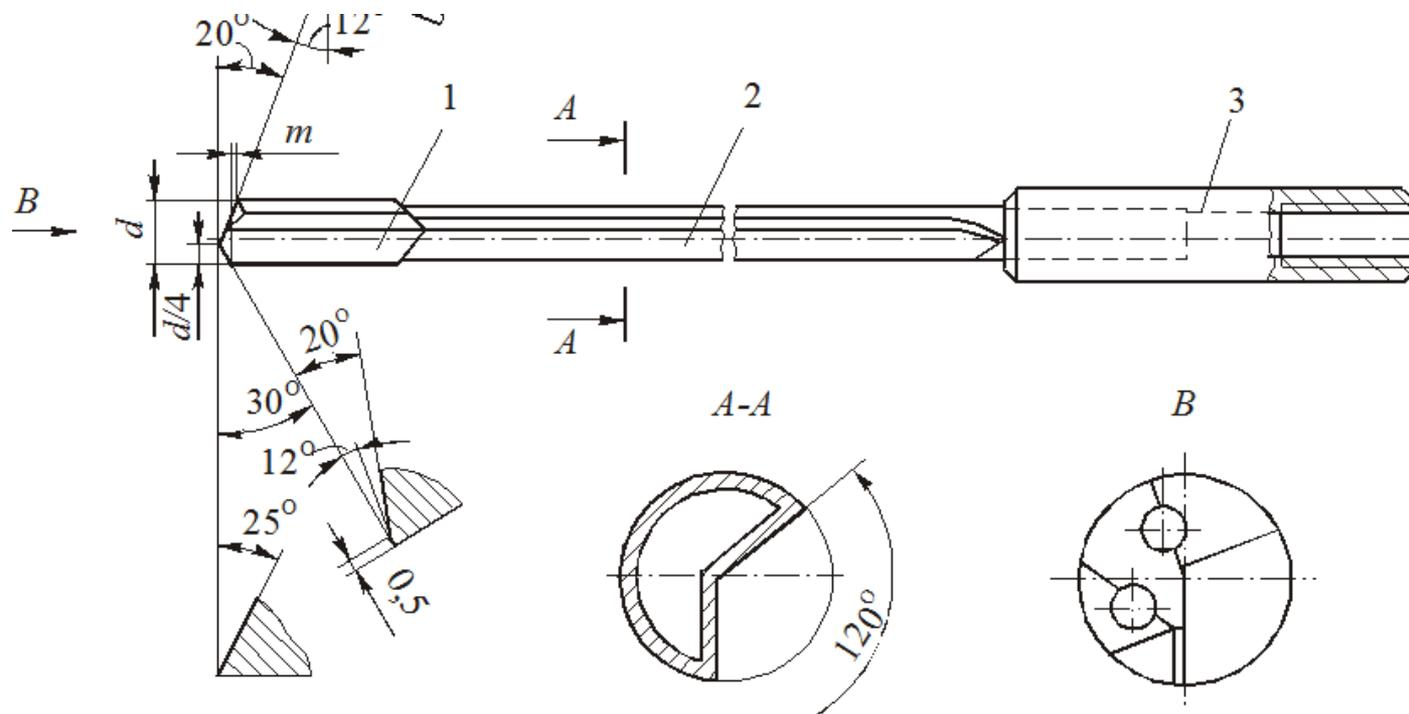
Ружейные сверла имеют внутренний канал для подвода СОЖ и прямую (иногда винтовую) канавку для наружного отвода пульпы (смесь стружки и СОЖ). Они применяются для сверления отверстий глубиной  $(5 \dots 100)d$  и диаметром  $1 \dots 30$  мм, минимальный увод оси при высокой точности ( $H8 \dots H9$ ) и низкой шероховатости ( $Ra 0,32 \dots 1,25$  мкм); СОЖ на масляной основе с противозадирными присадками (S, Cl, P)
