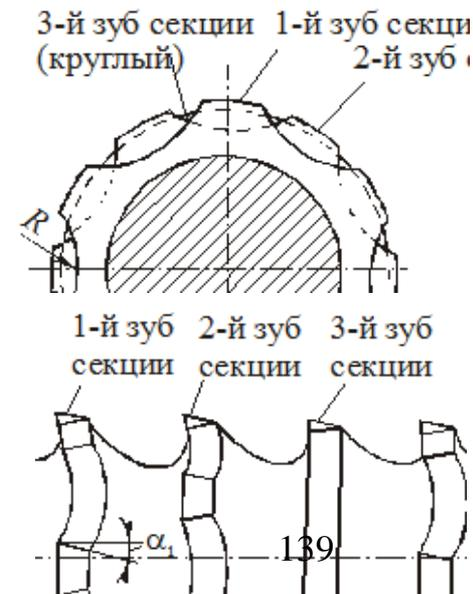
Каждый зуб снимает отдельные части припуска участками режущей кромки, где нет выкружек. Благодаря большой ширине выкружек снимаемая **стружка не имеет ребер жесткости**, хорошо скручивается в канавках между зубьями, даже при увеличении толщины среза до  $a_z = 0,4$  мм при обработке стали и до  $a_z = 1,2$  мм – при обработке чугуна. За счет этого при групповой схеме резания возможно существенное **сокращение длины режущей части** протяжки.
