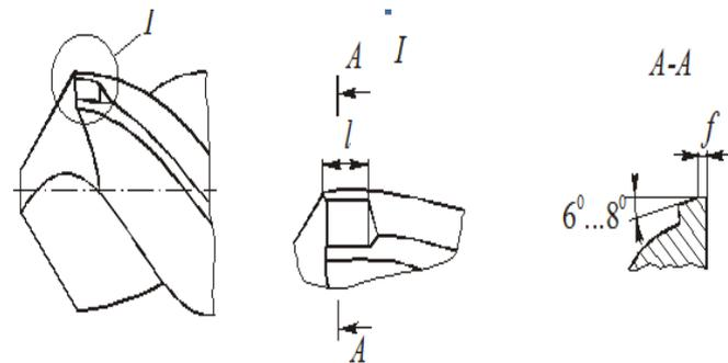
2) **подточка поперечной режущей кромки, снижающие осевую составляющую силы резания, улучшающие условия засверливания и увеличивающие производительность процесса сверления за счет увеличения подачи.**
