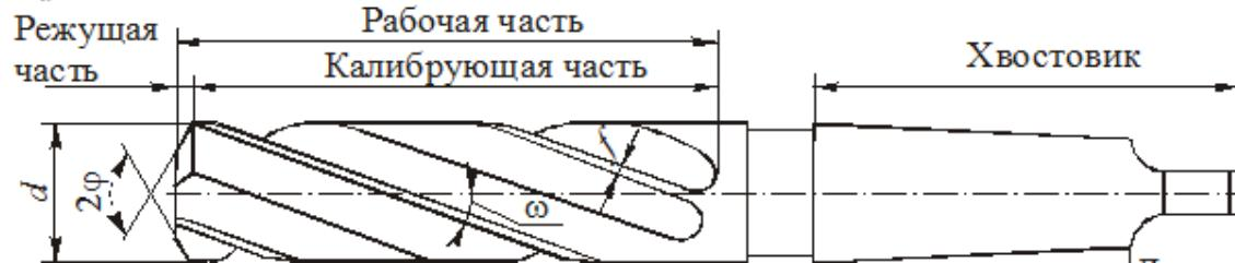
Цилиндрический хвостовой зенкер с коническим хвостовиком
