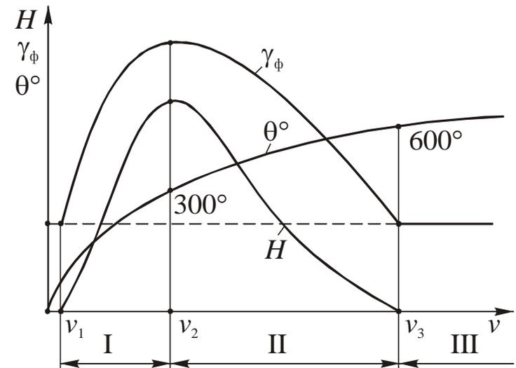
Схема влияния скорости резания  $v$  на температуру резания  $\Theta$ , высоту нароста  $H$  и фактическое значение переднего угла  $\gamma_{\phi}$
