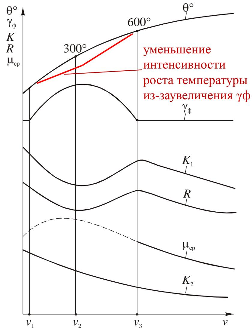
Схема взаимосвязи скорости резания  $v$ , температуры резания  $\Theta$ , фактического переднего угла  $\gamma_{\phi}$ , усадки стружки  $K$ , силы резания  $R$  и среднего коэффициента трения  $\mu_{\text{ср}}$
