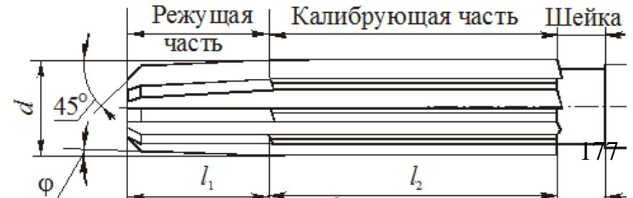
Если длина калибрующей части мала (особенно у машинных развёрток), то **обратную конусность** иногда делают сразу за **заборным конусом**, не оставляя цилиндрического участка. Общая длина рабочей части развёрток равна: у ручных развёрток  $l=(4\dots10)\cdot d$ , у машинных  $l=(0,75\dots2)\cdot d$ .
