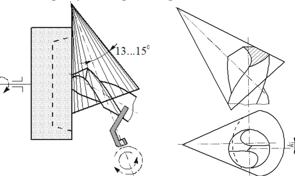
**Коническая заточка** – величина угла  $\alpha$  регулируется смещением  $k$  оси сверла.
