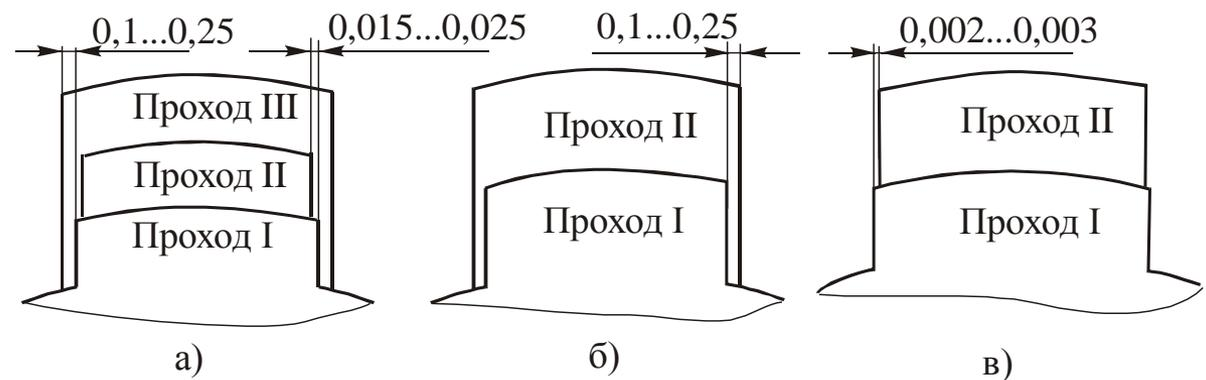
Распределение припуска между шлицевыми протяжками комплекта из: а – трех протяжек; 141 б – двух протяжек; в – двух протяжек ( $\Delta b > 0,06$  мм)
