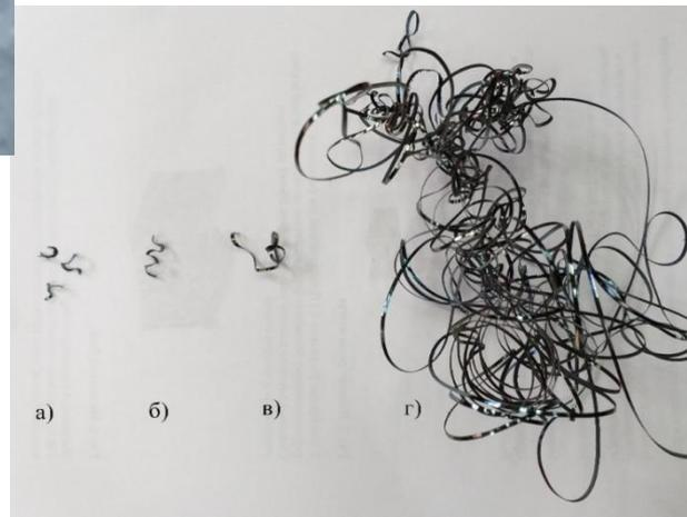
износ от закалённой на воздухе стружки
