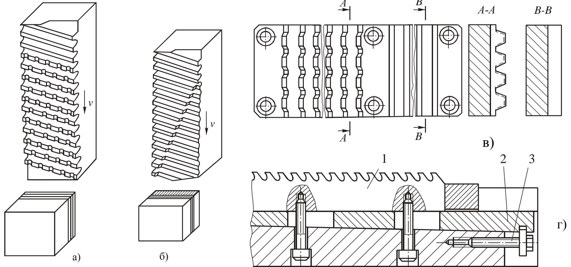
Схемы резания, применяемые при протягивании наружных поверхностей: *а* – профильная; *б* – генераторная с чистовыми зубьями, выполненными по профильной схеме; *в* – трапецеидальная схема; *г* – регулирование по высоте секции сборной наружной протяжки с помощью клина
