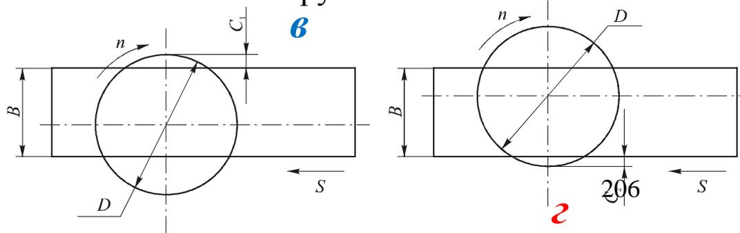
Для уменьшения неравномерности фрезерования используется большое количество зубьев, а у цилиндрических и концевых фрез дополнительно используется **косозубая** и **винтовая** форма стружечных канавок. Недостатки: 1) появляется составляющая  $P_x$  силы резания в осевом направлении; 2) увеличивается интенсивность износа из-за увеличения трения вдоль режущей кромки, что вызывает увеличение температуры резания.
