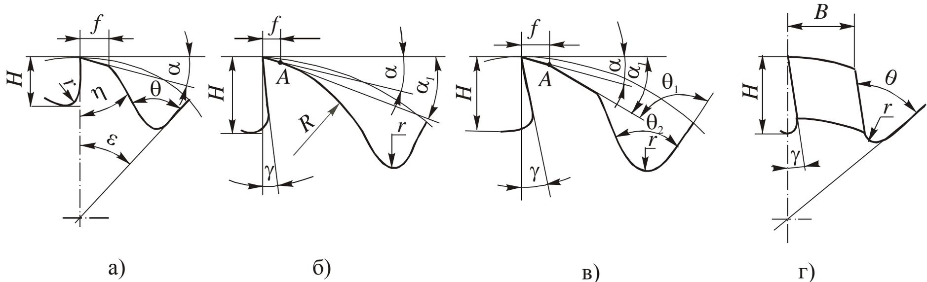
Формы зубьев фрез: *a* – трапецевидная; *б* – параболическая; *в* – усиленная; *г* – затылованный зуб
