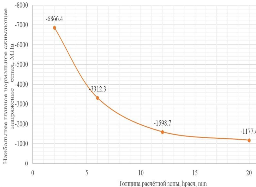
Влияние толщины режущей пластины  $h_{\text{пластины}}$  (мм) на величину наибольшего сжимающего нормального напряжения в режущем клине  $\sigma_{3 \max}$  (МПа). ВТЗ-1 – ВК8,  $\gamma=0^\circ$ ,  $v=1$  м\с,  $s=0,21$  мм/об,  $h_z=0,2$  мм [Чжан Ц., Хуан Ч., Козлов В.Н.]
