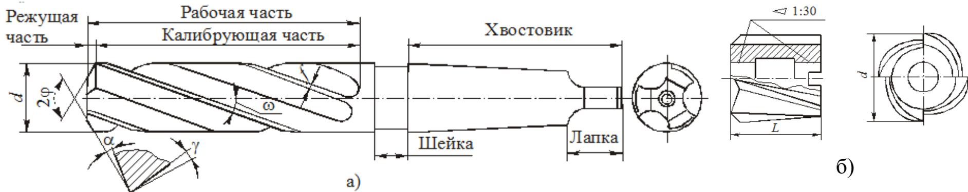
Цилиндрические зенкеры: а – хвостовой; б – насадной
