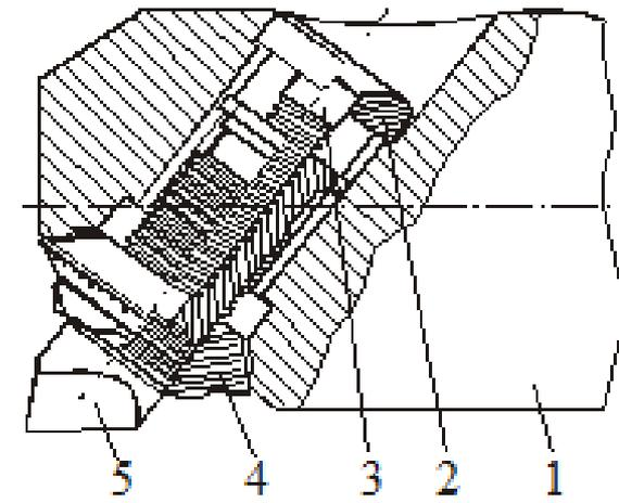
Для растачивания **точных отверстий** диаметром более 20 мм с **микрорегулированием** за  $\frac{1}{8}$  деление гайки 4 с шагом 0.5 мм ход резца на **0,01 мм**
