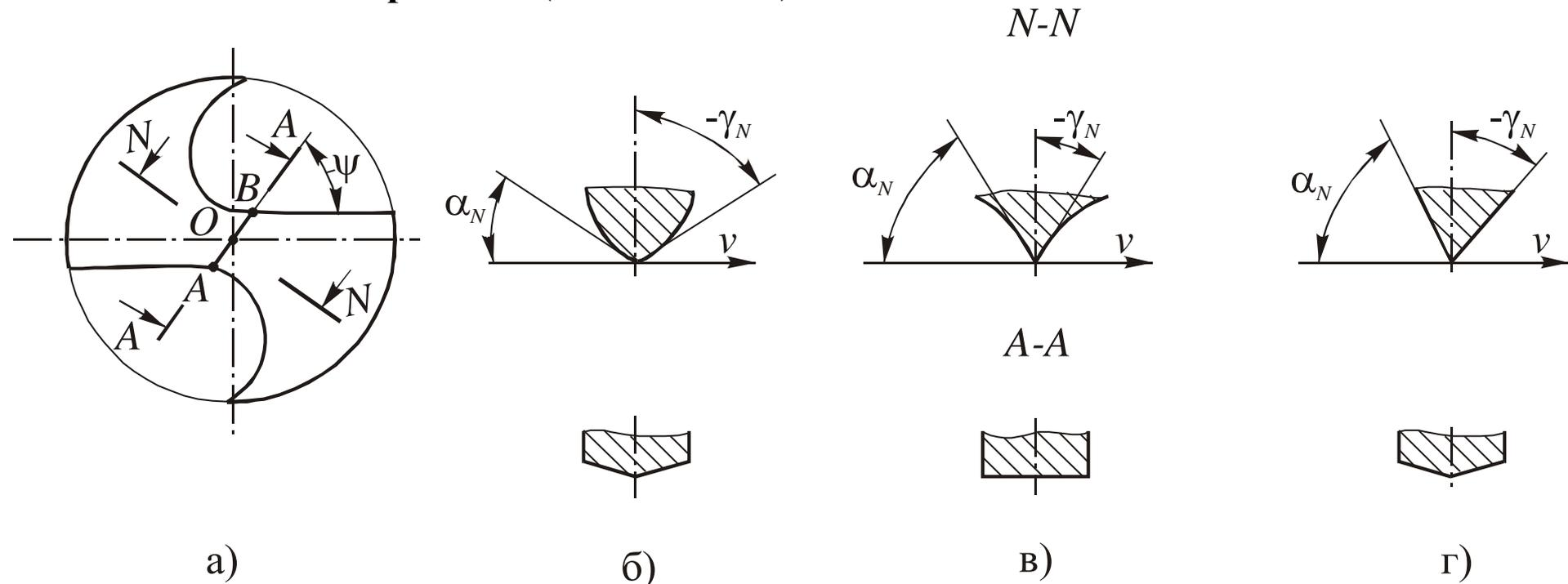
Геометрические параметры поперечной режущей кромки спирального сверла:
