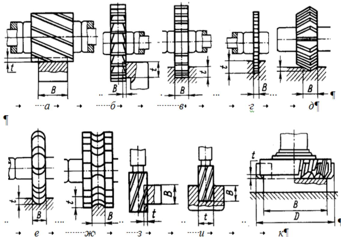
$t$  – глубина резания;  $B$  – ширина фрезерования;  $D$  – диаметр фрезы
