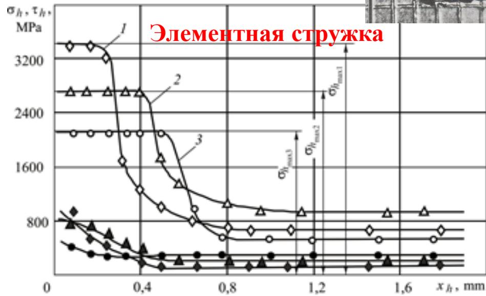
б) распределение нормальных ( $\diamond, \Delta, \circ$ )  $\sigma_h$  и касательных ( $\blacklozenge, \blacktriangle, \bullet$ )  $\tau_h$  контактных напряжений на искусственной фаске износа по задней поверхности при обработке титанового сплава, образующего элементарную стружку. ВТЗ-1 - ВК8,  $\gamma=0^\circ$ ,  $\alpha_h=0^\circ$ ,  $\alpha=10^\circ$ ,  $\nu=1$  м/с:
