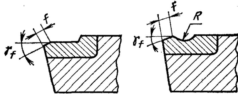
При получистовой и чистовой обработке **незакалённой стали** и других нетвёрдых материалов, канавка используется **отдельно без заточки фаски** и **выходит к главной режущей кромке**. Наличие канавки позволяет **увеличить главный передний угол  $\gamma$**  на участке контакта передней поверхности со стружкой без её существенной заточки с требуемым передним углом, что позволяет сохранить достаточную прочность режущего клина, **уменьшить трудоёмкость заточки** и расход инструментального материала.
