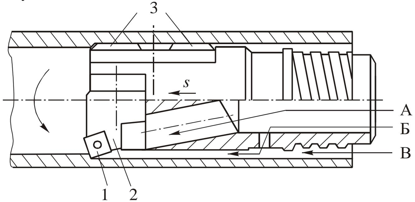
Расточная головка фирмы «Sandvik Coromant» (Швеция) для обработки гильз гидроцилиндров: A – с внутренним подводом СОЖ; B – с эжекторным отводом стружки; B – с наружным подводом СОЖ; 1 – твердосплавная режущая пластина; 2 – кассета; 3 – твердосплавная направляющая
