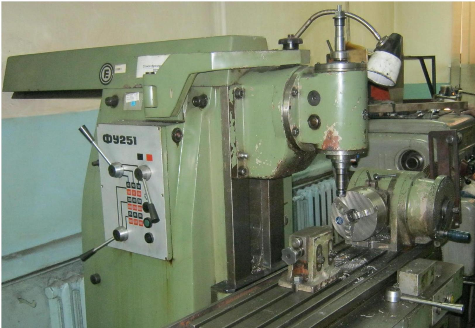
Консольный универсально -фрезерный станок ФУ 251 с делительной головкой на столе
