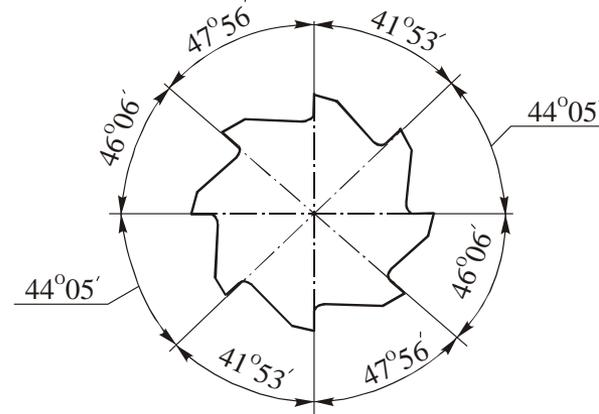
**Стружечные канавки** у разверток чаще всего **прямые**. Зубья изготавливают с **передним углом  $\gamma = 0^\circ$** . При обработке **вязких материалов** во избежание налипов стружки и вырывов на обработанной поверхности зубья затачивают с положительными углами  $\gamma = 5...10^\circ$ .
