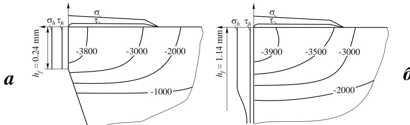
Распределение главного внутреннего напряжения  $\sigma_1$  в режущем клине резца при прямоугольном свободном течении диска из титанового сплава ВТЗ-1. [Козлов В.Н.]
