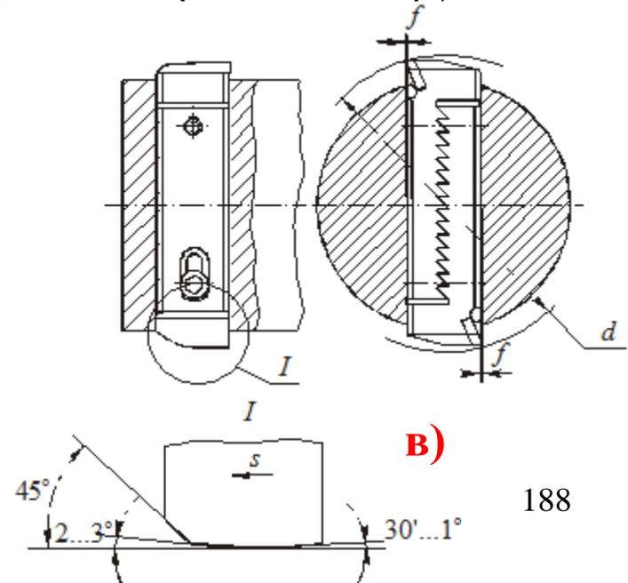
**Расточные головки** для обработки **неглубоких отверстий** имеют несколько режущих кромок ( $d = 120 \dots 300$  мм,  $z = 4 \dots 8$ ). Они жестко крепятся в оправке и применяются для **предварительной обработки** отверстий.
