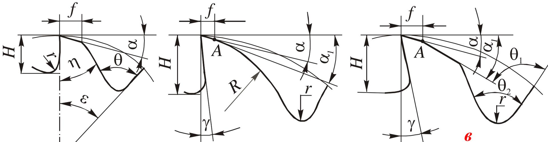
Формы зубьев *a* – трапециевидная; *b* – параболическая; ***v*** – усиленная;
