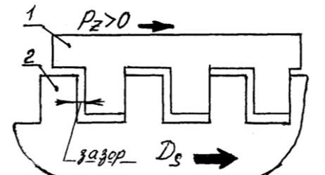
**б** - зазор **справа** от витка винта
