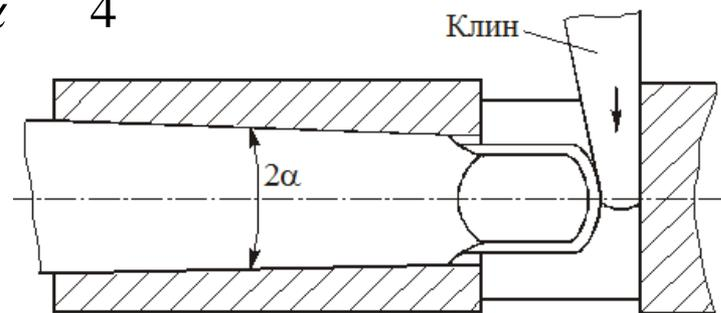
Хвостовики с лапкой и с затяжкой в гнездо болтом (штревелем). Лапка не должна передавать крутящий момент. Она предназначена только для выбивания инструмента из гнезда с помощью клина
