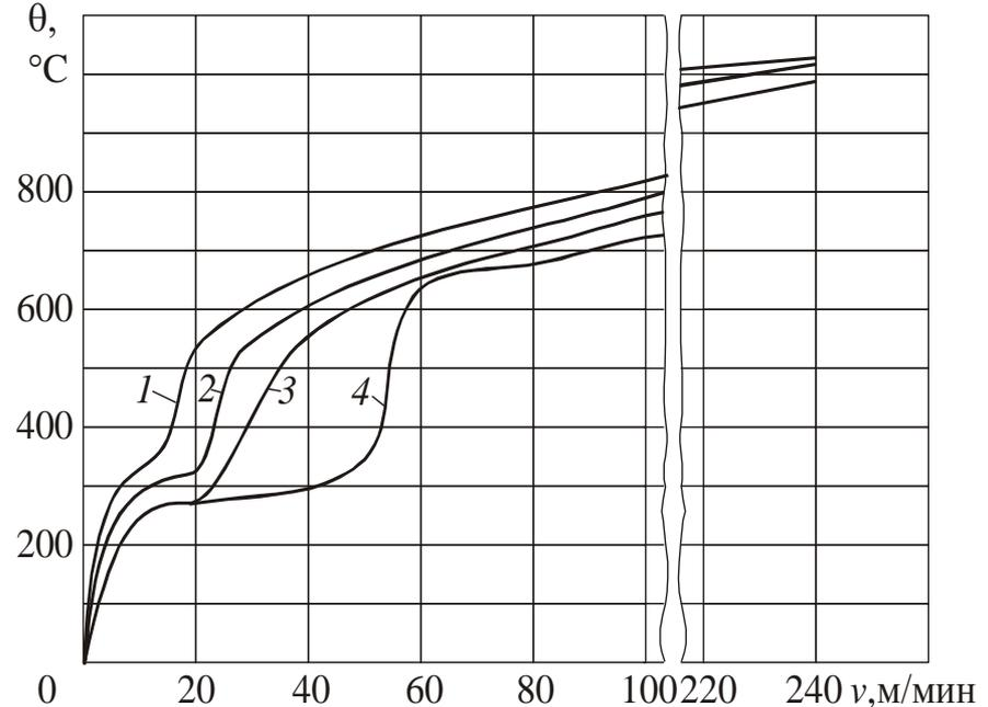
Рис.2. Влияние напорного охлаждения на **температуру резания  $\theta$**  при точении стали 30 ( $s=0,43$  мм/об,  $t=2$  мм,  $r=0,3$  мм,  $\gamma=0^{\circ}$ ,  $\varphi=70^{\circ}$ ): 1 – без СОЖ; 2 – масляная СОЖ типа МР-7; 3 – эмульсия (5% раствор эмульсола ЭТ-2); 4 – вода (Б.М. Орлов)
