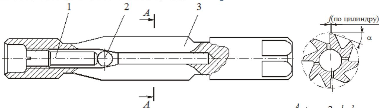
Величина  $\Delta$  регулирования диаметра небольшая и берется в зависимости от диаметра развертки, например, для  $d=10\dots20$  мм  $\Delta=0,25$  мм, для  $d=20\dots30$  мм  $\rightarrow \Delta=0,4$  мм, для  $d=30\dots50$  мм  $\Delta=0,5$  мм.
