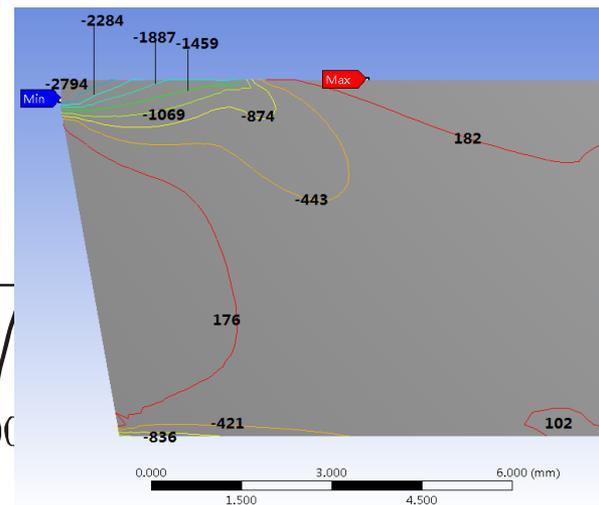
Распределение главного внутреннего напряжения  $\sigma_1$  в режущем клине резца при прямоугольном свободном течении диска из **титанового сплава ВТ3-1**. [Козлов В.Н.]
