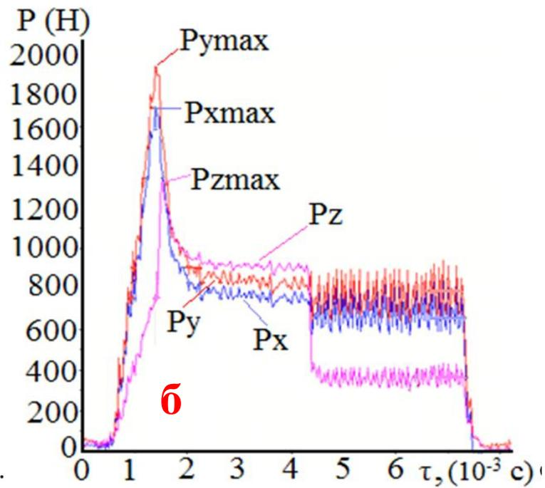
Изменение составляющих силы резания при обработке стали 40Х. Ордината – составляющие силы резания (Н), абсцисса – время обработки  $\tau$  (с).
