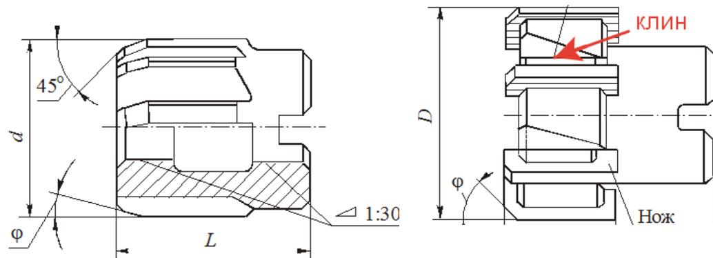
$\varphi$  – развертка насадная;  $\varphi$  – развертка сборная
