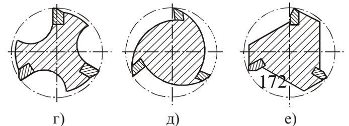
При проектировании новых зенкеров рекомендуются следующие значения **передних** углов: при обработке **сталей**  $\gamma_N=8...12^\circ$ , чугунов  $\gamma_N=6...10^\circ$ , цветных металлов  $\gamma_N=25...30^\circ$ , твердых сталей и чугунов  $\gamma_N=0...5^\circ$ .
