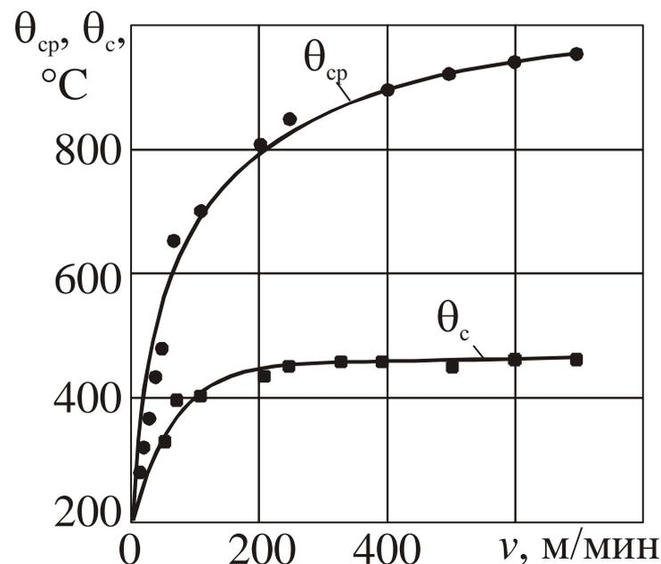
Влияние скорости резания на среднюю температуру **на передней поверхности**  $\theta_{cp}$  и температуру **в стружке**  $\theta_c$  при точении стали 40X 59 (Т15К6,  $t=1,5$  мм,  $s=0,12$  мм/об)
