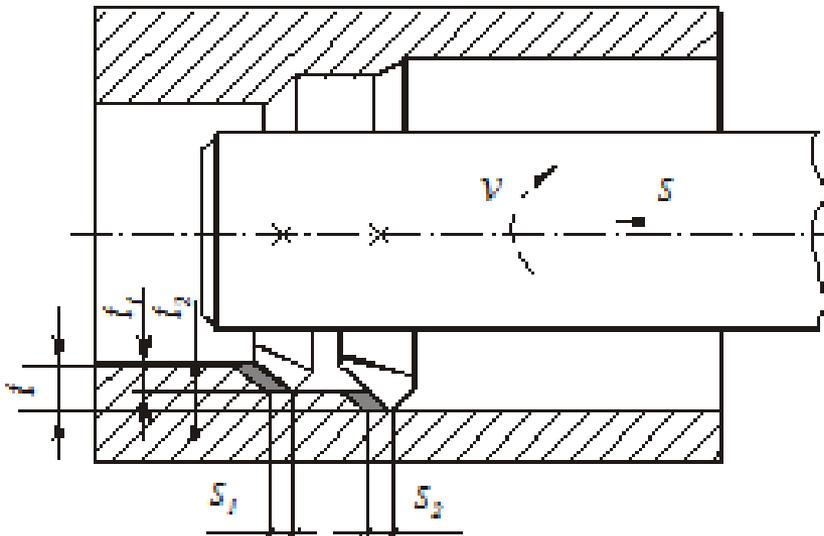
При **схеме деления подачи** каждая режущая кромка головки снимает **полную глубину резания  $t$** , а подача  $s$  на один оборот инструмента или заготовки равна сумме подач, приходящихся на каждый зуб, смещённые вдоль оси
