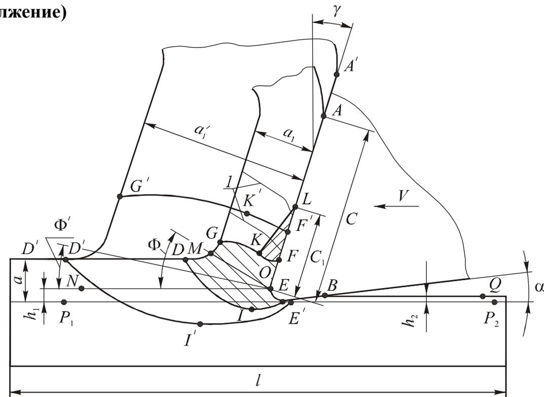
Схема упруго-пластической деформации в зоне стружкообразования при строгании пластины
