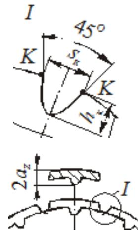
Жёсткость **стружки** мешает ее завиванию во впадине между зубьями - она упирается в дно впадины, в результате чего возможны ее заклинивание. Канавки прорезают шлифовальным кругом при небольшом ( $2 \dots 3^\circ$ ) **поднятии заднего центра** протяжки для **создания заднего угла по дну канавки**. При этом ослабляются режущие кромки зубьев в точках **K** пересечения канавок с задней поверхностью и приводит к более интенсивному износу зубьев на этих участках.
