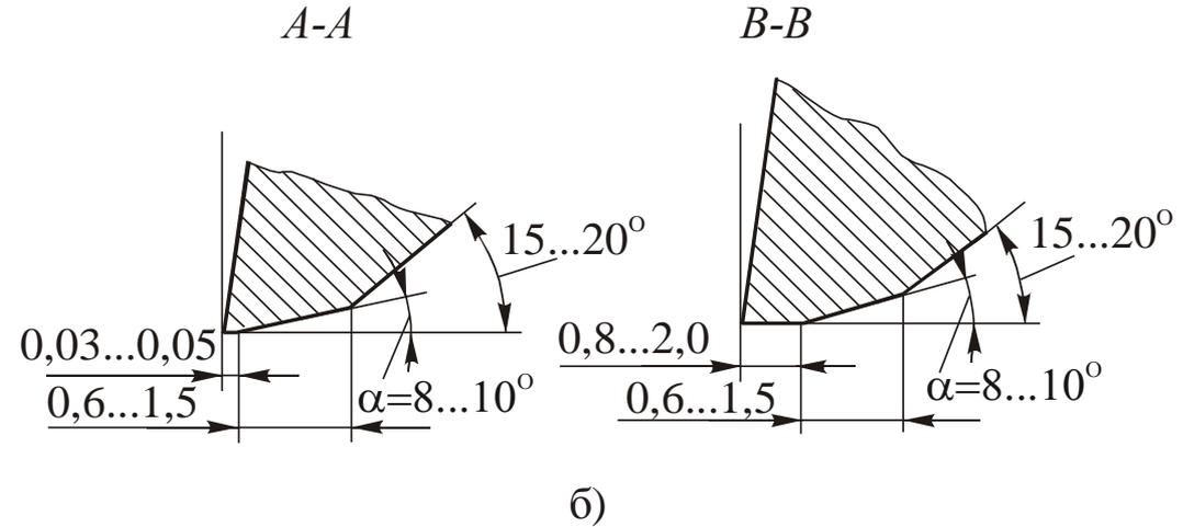
**Режущая часть** зенкера: *a* – элементы режущей части; *б* – формы заточки зубьев зенкера
