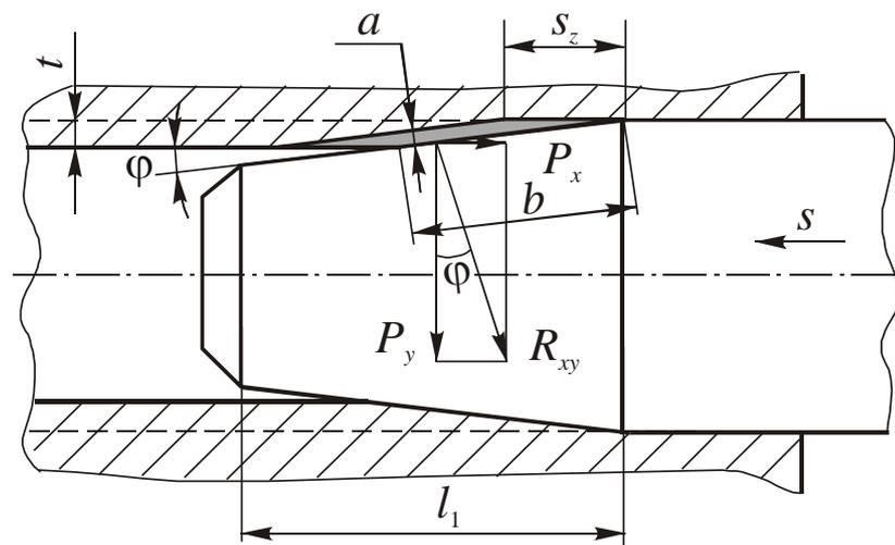
Радиальная  $P_y$  и осевая  $P_x$  составляющие силы резания и параметры сечения срезаемого слоя
