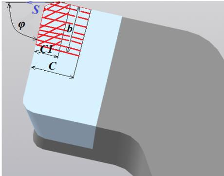
Измерение общей длины контакта стружки  $c$  и длины пластического контакта стружки  $c_1$  с передней поверхностью резца
