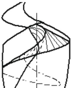
**Винтовая заточка** - в серийном производстве сверл
