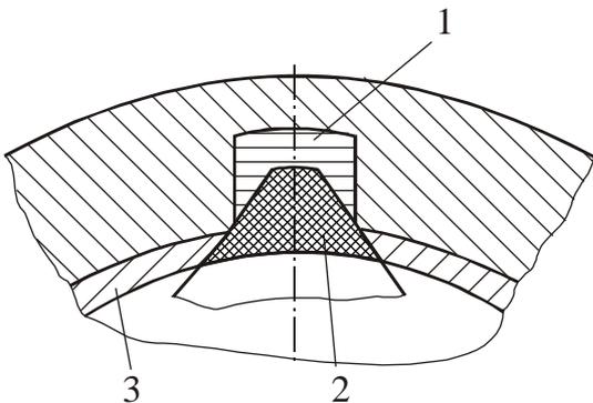
Припуск, снимаемый зубьями комбинированной шлицевой протяжки: 1 – шлицевыми; 2 – фасочными; 3 – круглыми
