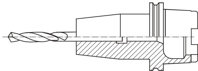
Крепление по «горячей» посадке сверла в патроне типа *HSK* для сверхскоростной обработки
