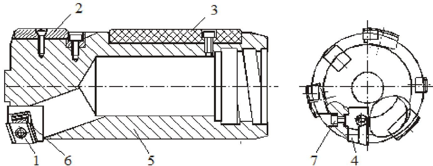
Расточная головка фирмы «Votek» (Германия) для обработки глубоких отверстий: 1 – твердосплавная режущая пластина; 2 – твердосплавная направляющая; 3 – пластмассовая направляющая; 4 – кассета; 5 – корпус головки; 6 – клин; 7 – винт
