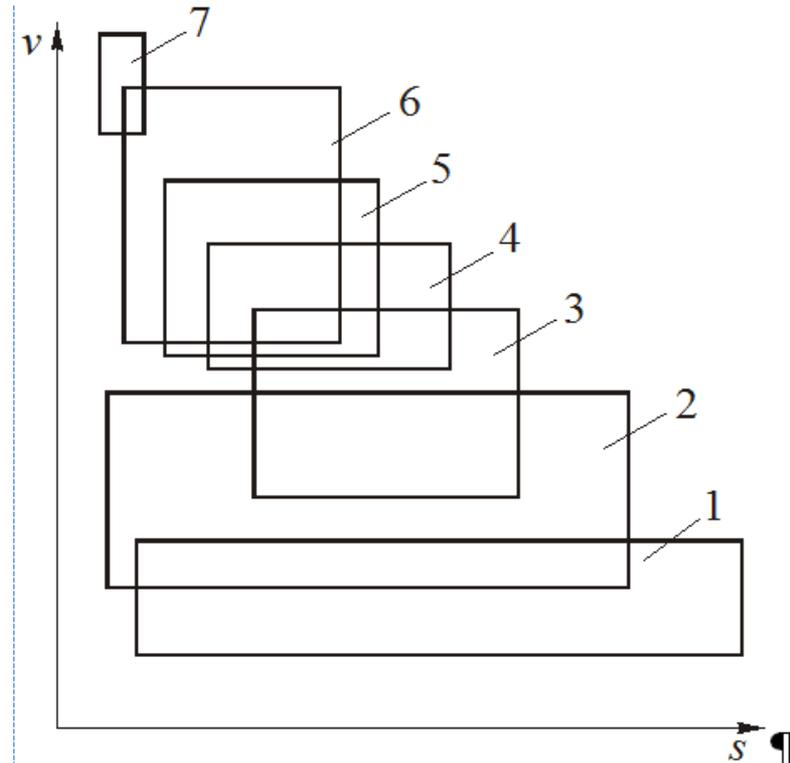
Рис. 1. Области применения режущих материалов по скорости резания  $v$  и подаче  $s$ : 1 – быстрорежущие стали; 2 – твердые сплавы; 3 – твердые сплавы с покрытиями; 4 – нитридная керамика; 5 – черная керамика (керметы); 6 – оксидная (белая) керамика; 7 – кубический нитрид бора
