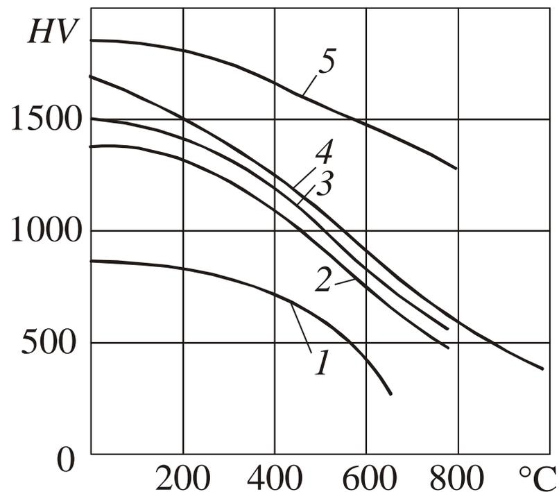
Влияние температуры на «горячую» твердость по Виккерсу некоторых инструментальных материалов: 1 - быстро-режущая сталь; 2 - твердый сплав марки ВК10; 3 - твердый сплав марки ВК6; 4 - твердый сплав группы ТТК; 5 - минералокерамика
