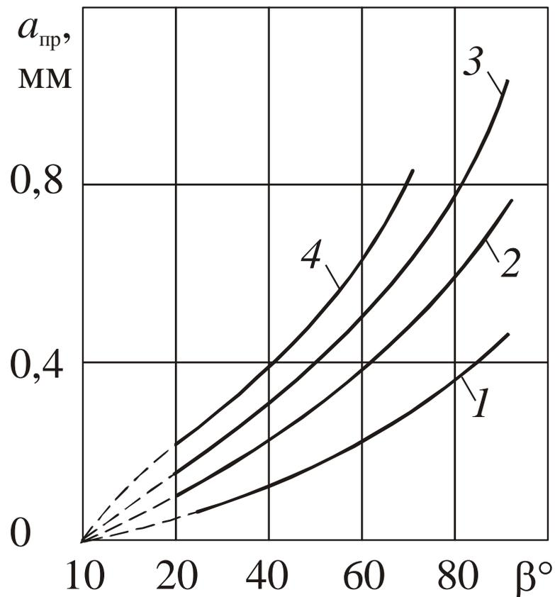
Влияние угла заострения режущего клина на предельную толщину срезаемого слоя при точении:
