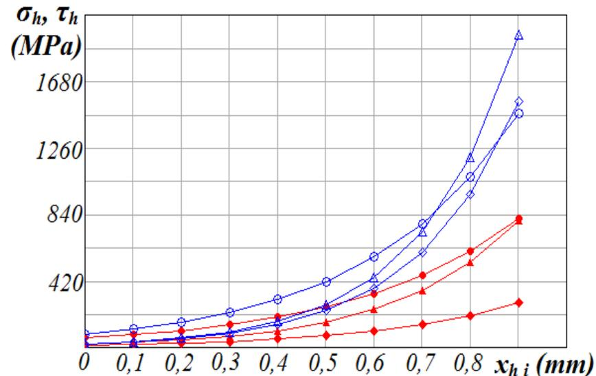
На **фаске износа задней поверхности** при обработке стали 40Х распределение контактных напряжений **коренным образом отличается от распределения на передней поверхности.**
