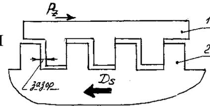
Схема выборки зазора в винтовой передаче при **встречном** фрезеровании;
