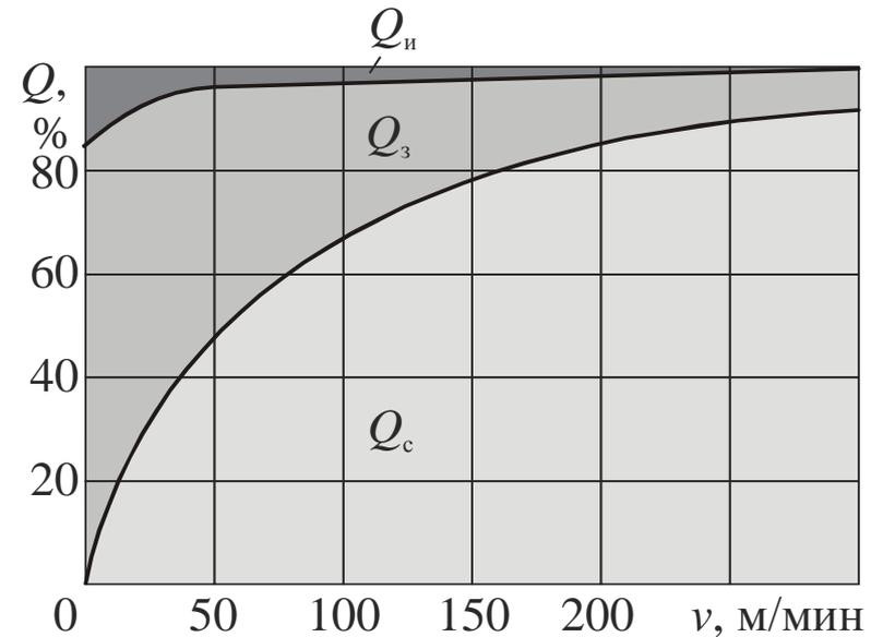
Распределение теплоты между стружкой, заготовкой и инструментом при точении стали 40X ( $T15K6$ ,  $t=1,5$  мм,  $s=0,12$  мм/об)
