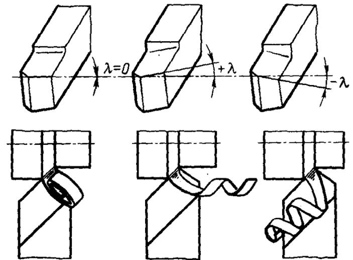
На практике при измерении угла часто исходят из другого, более общего, определения: угол  $\lambda$  - это угол между **вектором скорости резания** и **перпендикуляром к главной режущей кромке**
