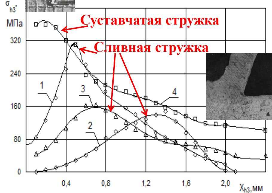
а) распределение нормальных  $\sigma_h$  и касательных  $\tau_h$  контактных напряжений на фаске задней поверхности инструмента при **сливном стружкообразовании**. Л63-Р6М5,  $\gamma=0^0$ ,  $\alpha_\phi=0^0$ : 1 -  $S=0,06$  мм/об,  $V=100$  м/мин; 2 -  $S=0,21$  мм/об,  $V=100$  м/мин; 3 -  $S=0,21$  мм/об,  $V=217$  м/мин.
