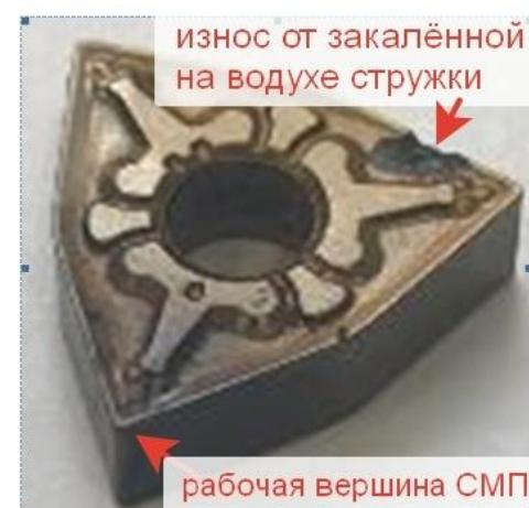
**Изменение формы стружки после локального износа в зоне контакта главной режущей кромки с необработанной поверхностью заготовки (наматывание стружки вокруг державки резца и заготовки - рис. б)**
