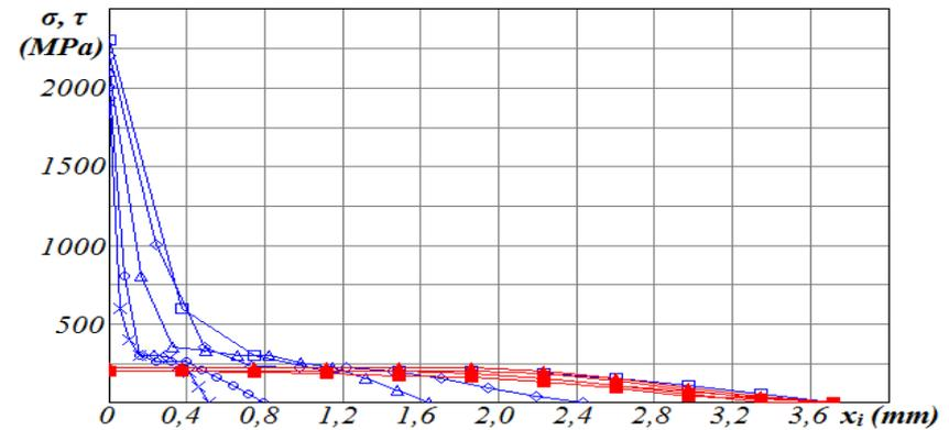
При исследовании распределения контактных напряжений на **фаске износа задней поверхности** с помощью разрезного резца упругая деформация элементов 3 приводит к **появлению уступа**, который начинает срезать дополнительную стружку с поверхности резания. **Зазор забивается**, что приводит к поломке пластин.
