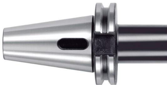
По причине избыточности длины конуса Морзе при некотором его применении, был образован стандарт укороченных конусов. В обозначении конуса находится значение наибольшего диаметра образованного после уменьшения длины при сохранении соотношения. Таким образом девять типоразмеров укороченных конусов, B7, B10, B12, B16, B18, B22, B24, B32, B45 получили распространение при установке сверлильных патронов и другого инструмента.
