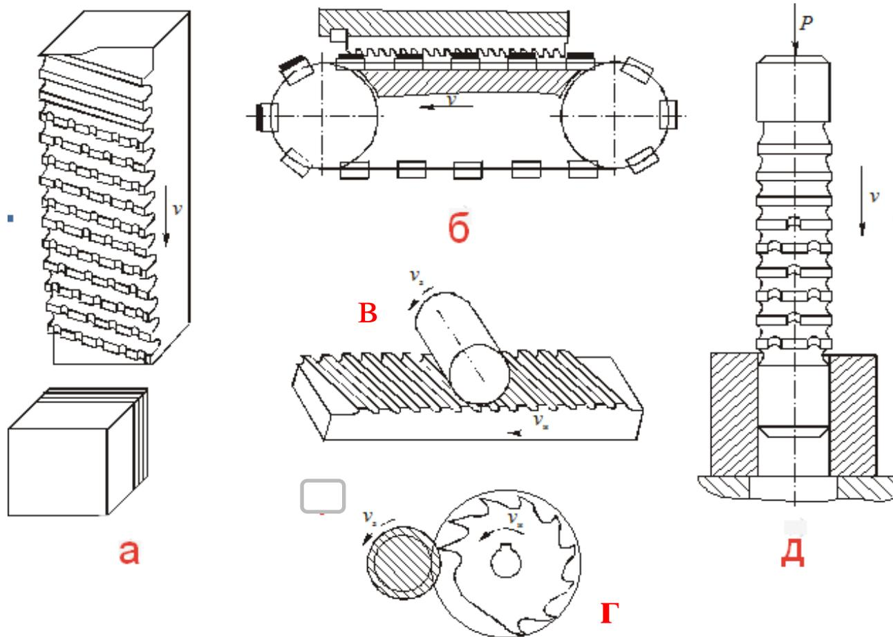
Схемы протягивания: **а** – плоскостей; **б** – непрерывное протягивание наружной поверхности; **в** – обработка цилиндрической поверхности плоской протяжкой; **г** – обработка цилиндрической поверхности круглой протяжкой; **д** – обработка отверстия прошивкой
