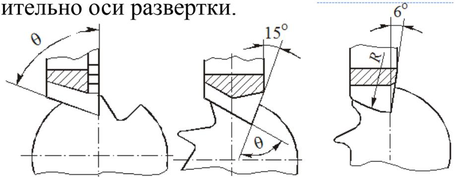
Во избежание самозатягивания и заедания развертки в отверстиях **направление винтовых канавок** развёртки должно быть **обратным направлению её вращения**. При этом шероховатость обработанной поверхности уменьшается, а усилие подачи возрастает. У **ручных** разверток допускается совпадение направления винтовых канавок с направлением вращения, так как они работают с малой подачей.
