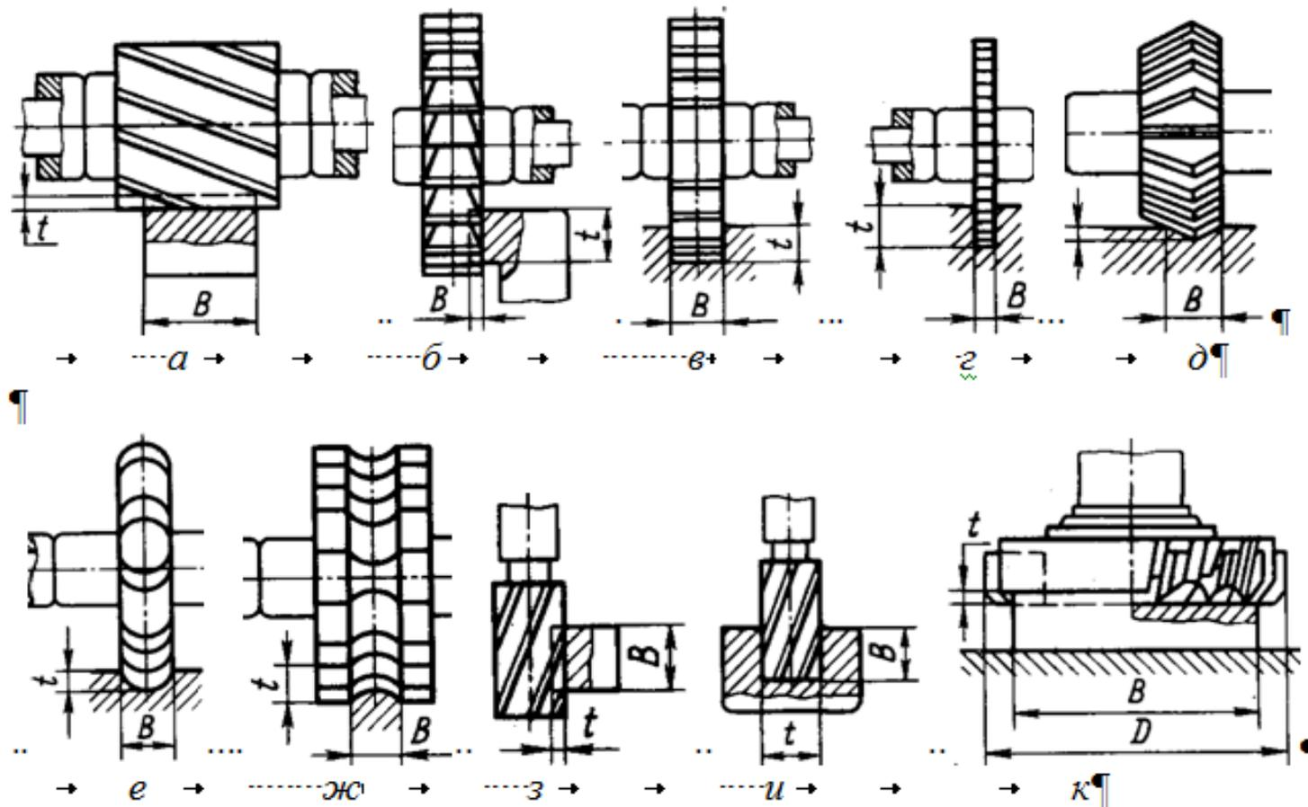
**Типы фрез** и элементы срезаемого слоя металла: *a* – цилиндрические; *б* – дисковые трехсторонние; *в* – дисковые пазовые; *г* – дисковые прорезные и отрезные; *д* – дисковые угловые; *е* – дисковые фасонные с выпуклым профилем; *ж* – дисковые фасонные с вогнутым профилем; *з*, *и* – концевые; *к* – торцовые.
