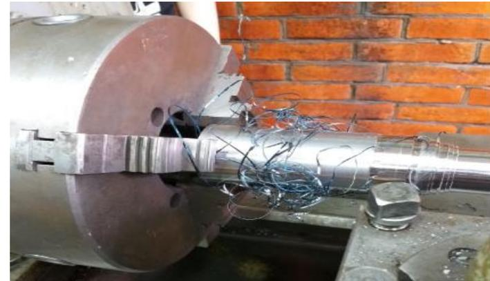
износ в зоне контакта главной режущей кромки СМП с необработанной поверхностью заготовки
