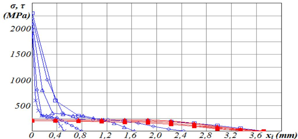
Рис. 2. Распределение **нормальных  $\sigma$**  ( $\times$ ,  $\circ$ ,  $\Delta$ ,  $\diamond$ ,  $\square$ ) и **касательных  $\tau$**  ( $+$ ,  $\bullet$ ,  $\blacktriangle$ ,  $\blacklozenge$ ,  $\blacksquare$ ) контактных напряжений (МПа) на **передней** поверхности резца при точении
