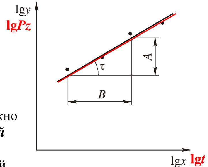
Схема для определения показателя степени  $k$  в уравнении  $y = C_x \cdot x^k$ .
