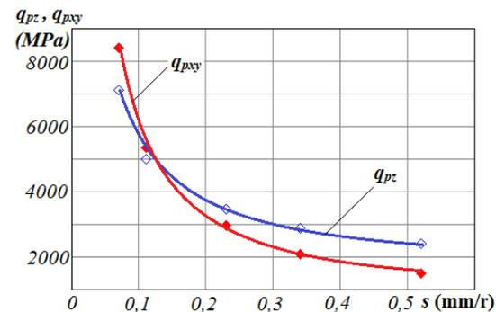
Влияние подачи  $s$  (мм/об) на удельные силы резания при обработке стали 40Х при разной фаске на задней поверхности  $h_3$ . Сталь 40Х- Т15К6;  $t=2 \text{ мм}$ ;  $v=2 \text{ м/с}$ , округление режущей кромки  $\rho \approx 5 \text{ мкм}$ .
