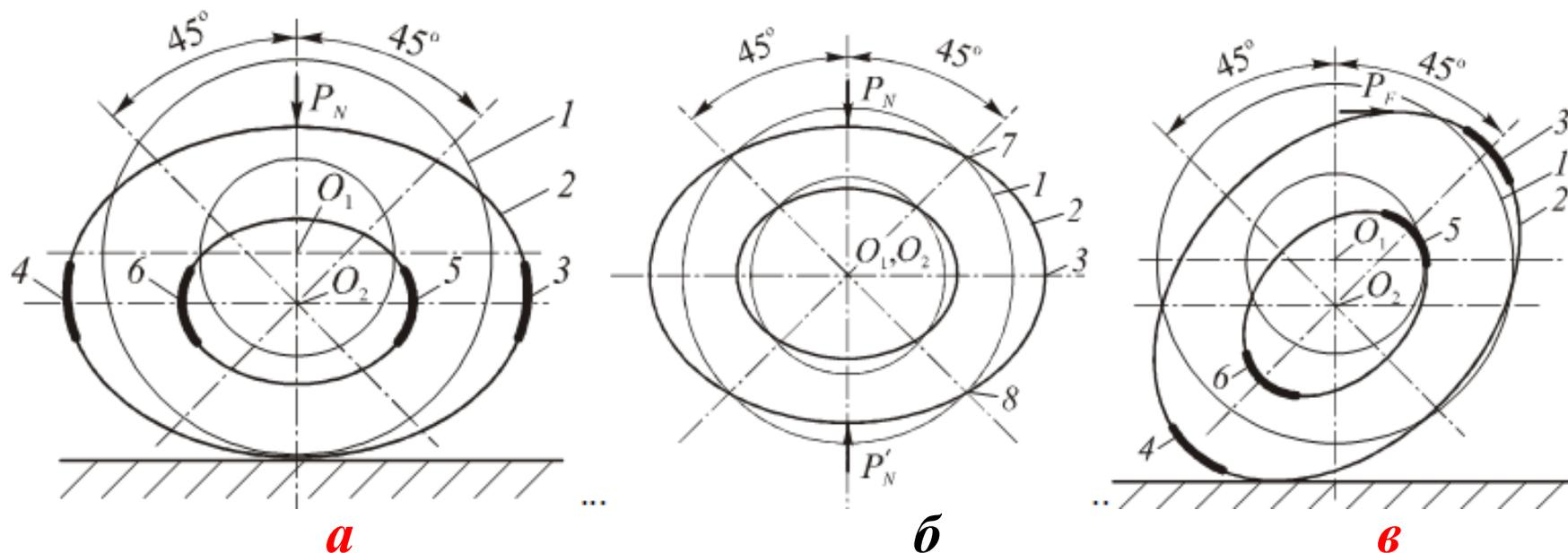
Схема деформирования упругого элемента динамометра: **а** – схема деформирования кольца под воздействием только **вертикальной силы  $P_N$** ; **б** – схема деформирования кольца под воздействием только вертикальной силы  $P_N$  сверху и снизу, при которой ось кольца не смещается; **в** – схема деформирования кольца под воздействием только **горизонтальной** силы  $P_F$ ;
