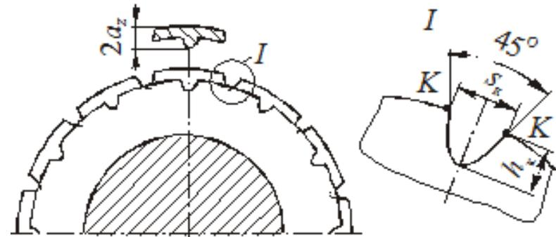
Так как кольцевая стружка недопустима, то для **деления стружки по ширине** на режущих кромках необходимо делать стружкоделительные **канавки V-образной формы**, которые располагают **в шахматном порядке** при переходе от одного зуба к другому.
