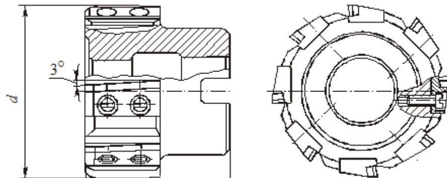
**Развертки одностороннего резания** изготавливают с одним или несколькими ножами и опорными пластинами в диапазоне диаметров 8...100 мм, и применяются для развертывания **неглубоких отверстий**. Режущие пластины у них могут быть регулируемы по диаметру с использованием разных способов механического крепления.
