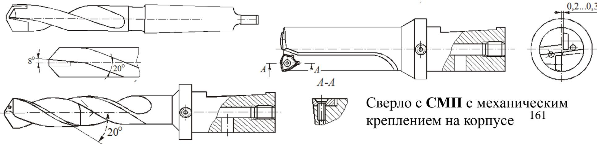
Сверло с СМП с механическим креплением на корпусе
