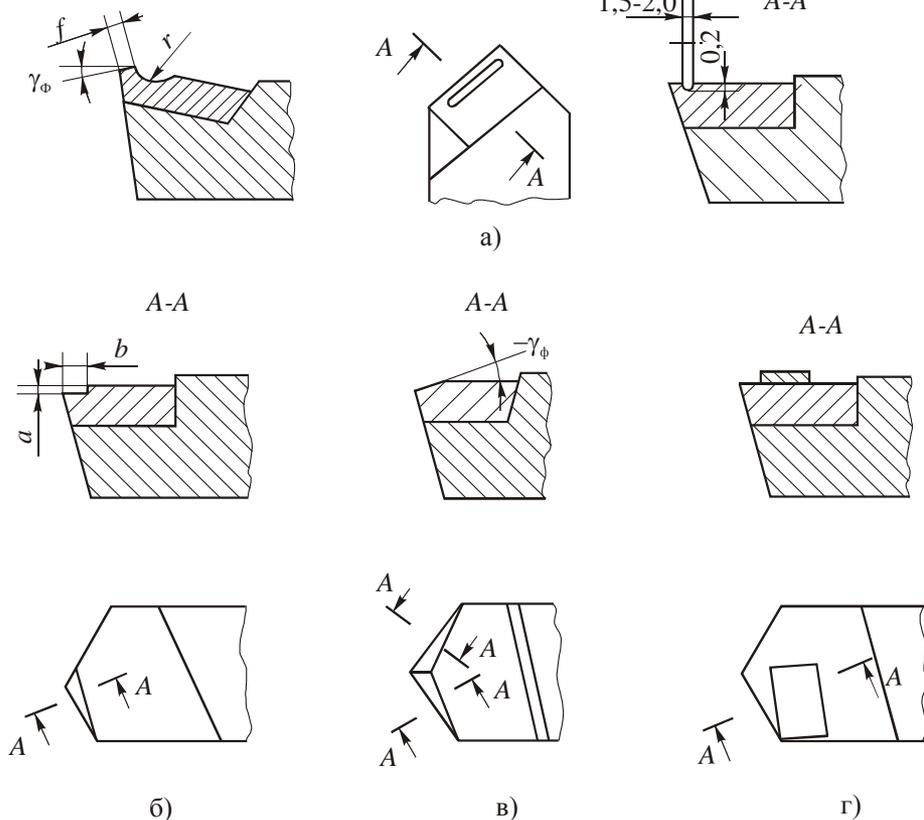
Рис. 1. Способы стружколомания и стружкозавивания:
