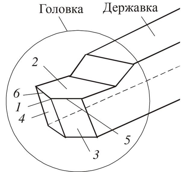
Поверхности и грани (режущие кромки) резца
