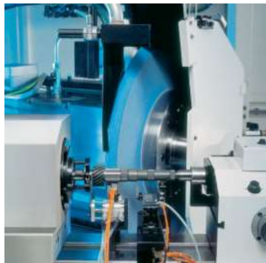
Круглое продольное шлифование с подшлифовкой торца уступа заготовки
