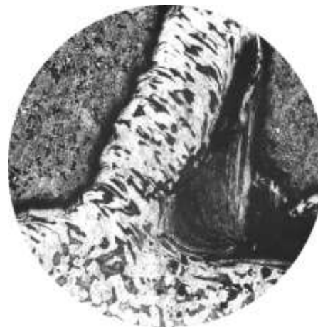
Микрофотография «корня» стружки (Б.М. Орлов)
