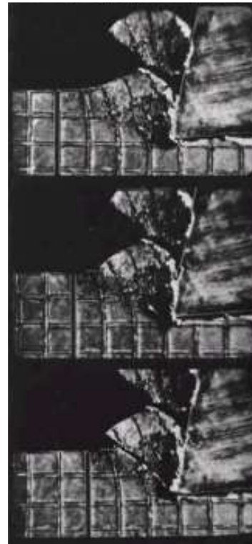
Формирование элементарной стружки со сдвигом элементов стружки по плоскости сдвига при строгании пластины (увеличено в 5 раз)
