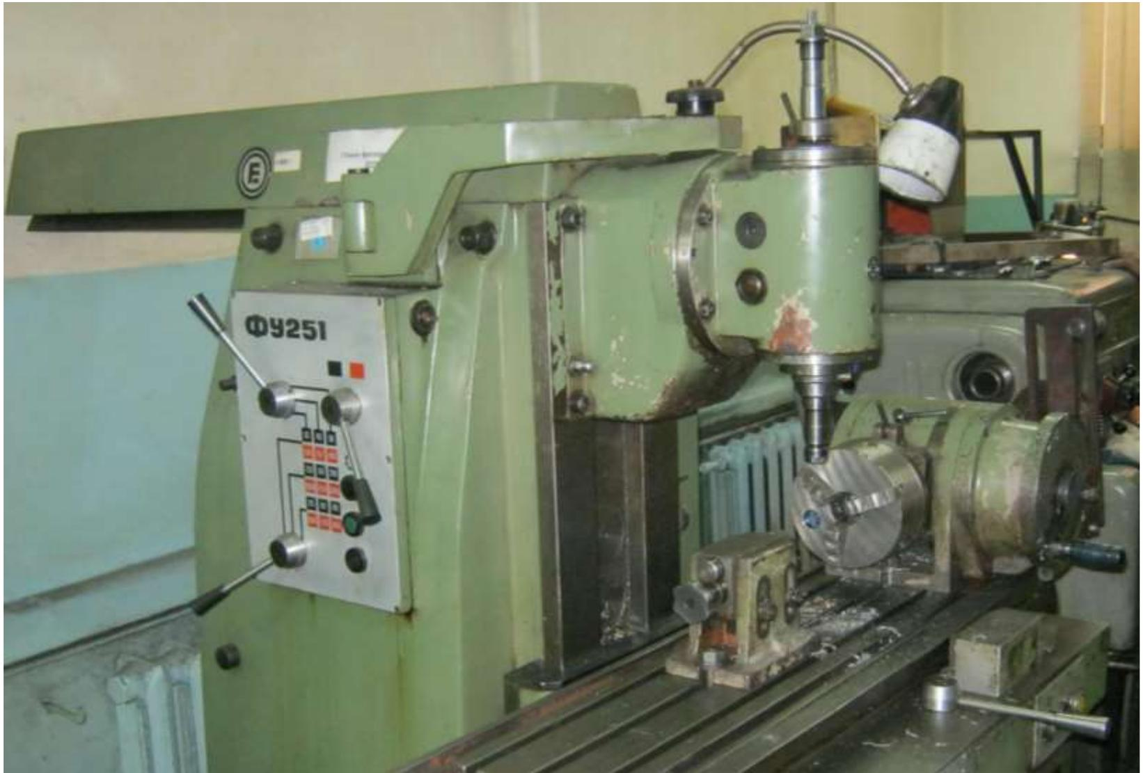
Консольный **универсально** -фрезерный станок ФУ 251 с делительной головкой на столе
