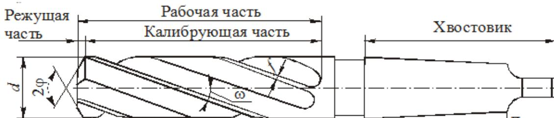
Цилиндрический хвостовой зенкер с коническим хвостовиком
