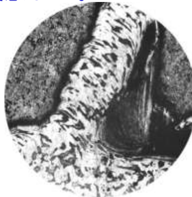
Микрофотография «корня» стружки (Б.М. Орлов)
