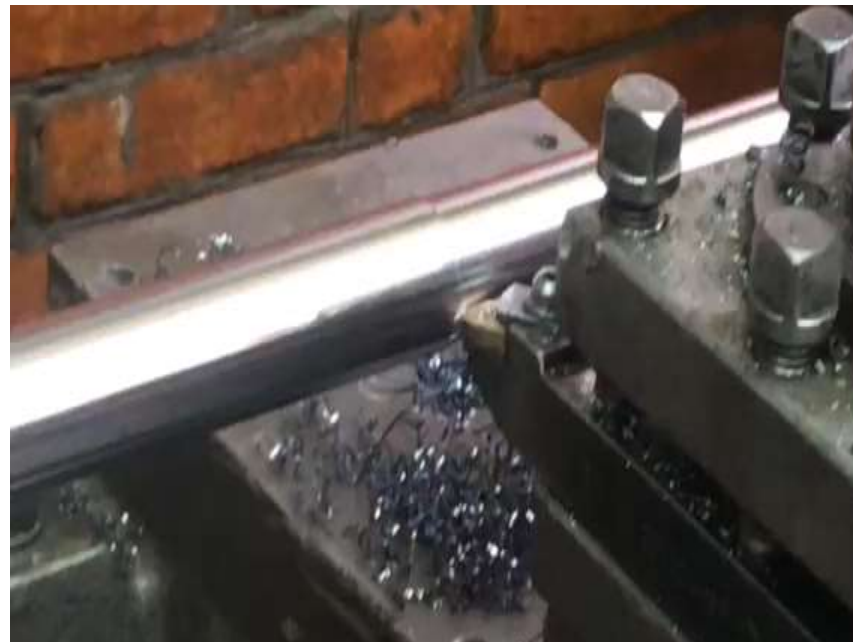
б) Процесс стружкообразования после локального износа.
