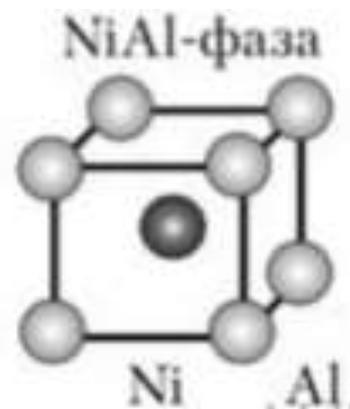
В поликристаллическом состоянии материал является чрезвычайно хрупким. С целью повышения пластичности целесообразно введение в сплав микродобавок **бора, циркония, гафния, хрома, марганца и железа.**
