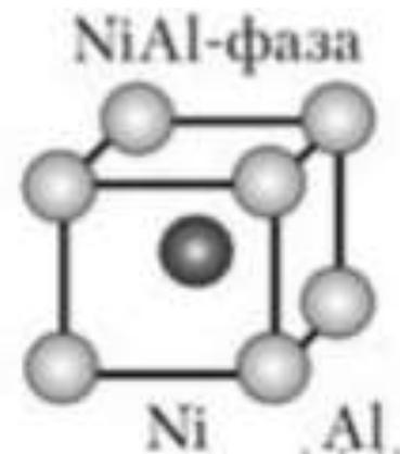
С целью повышения механических характеристик 36 соединение NiAl легируют такими элементами как **Cr, Ti, Zr и Hf**. Предел текучести легированного сплава может достигать **600 МПа**. При высоких скоростях охлаждения соединение NiAl претерпевает мартенситное превращение с образованием структуры типа L10.
