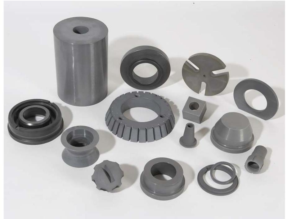
**SiAlON** характеризуется уникальным сочетанием еще более высокой твердости по сравнению с обычным нитридом кремния с таким же высоким уровнем прочности.
