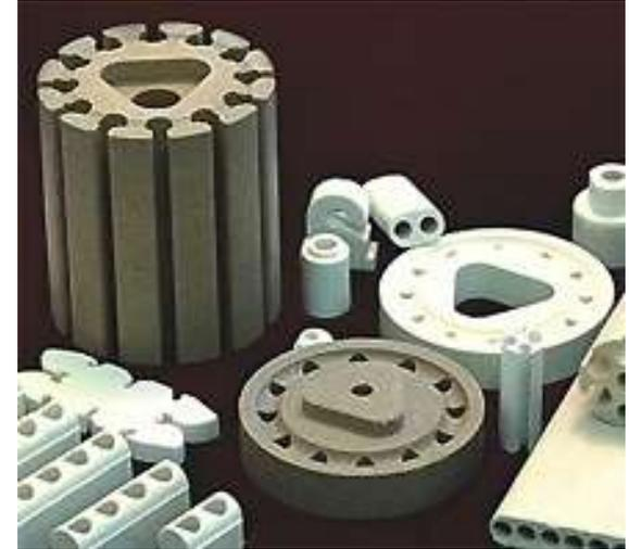
При оценке механических свойств, техническая керамика лучше работает на сжатие, чем на растяжение, изгиб или удар. На **прочностные характеристики** оказывает влияние **микроструктура материала, природа межатомных сил в фазах, пористость, макро - и микродефектность, количественное соотношение кристаллической и аморфной фаз.**
