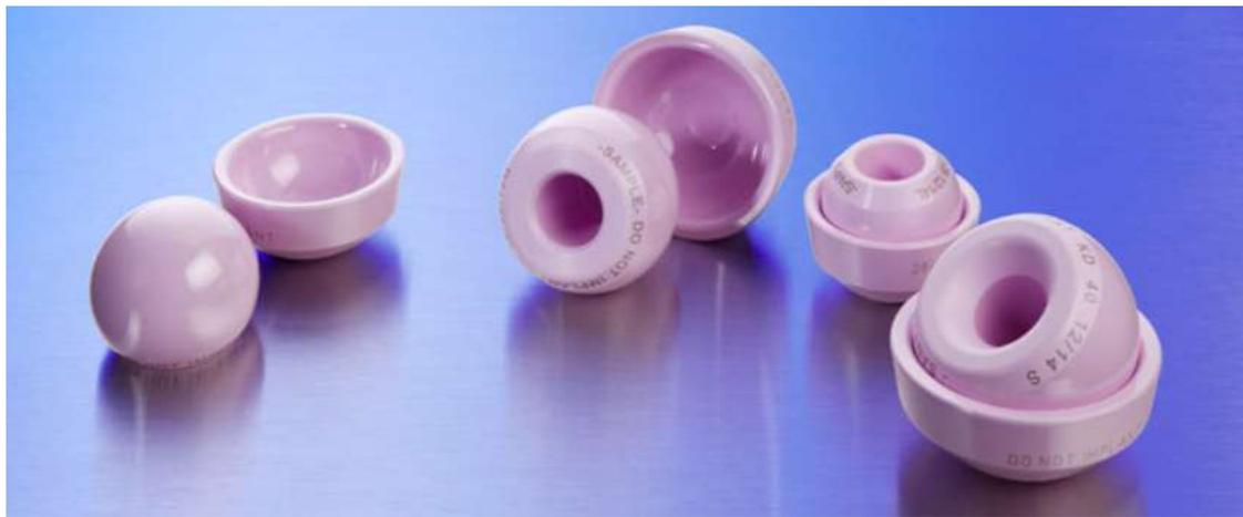
Негативная характеристика  $ZrO_2(Y_2O_3)$  – деградация механических свойств под воздействием влаги при температурах до  $300^{\circ}C$ .
