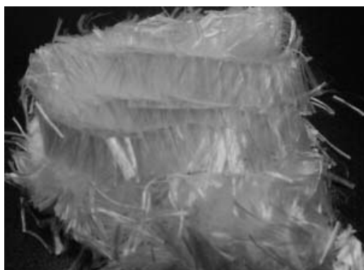
Рис.5.7. Стекловолокно часто используется в качестве наполнителя в композиционных материалах
