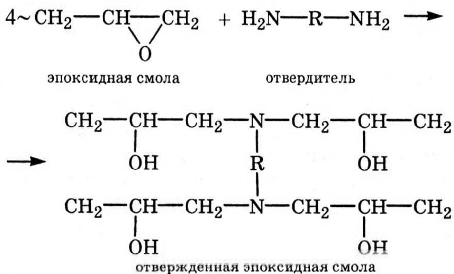
Рис. 5.3. Реакция отверждения эпоксидной смолы
