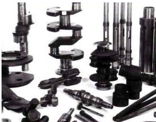
*Рис. 4.27. Детали машин после закалки и высокого отпуска*
