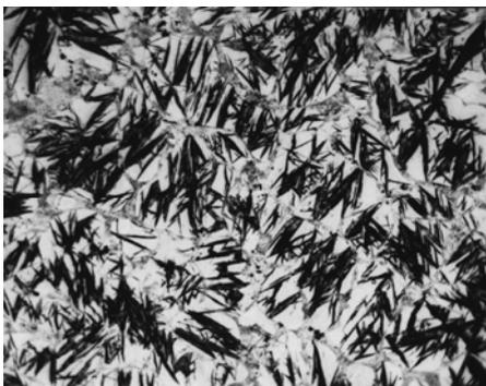
Рис. 4.23. Структура мартенсита закаленной стали 45
