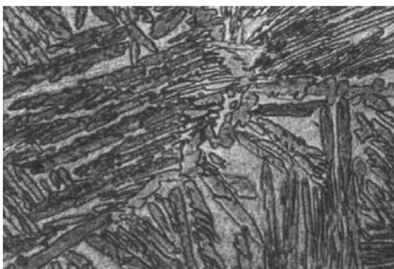
Рис. 3.10. Микроструктура титанового сплава ВТ6 после закалки ( $\times 400$ )
