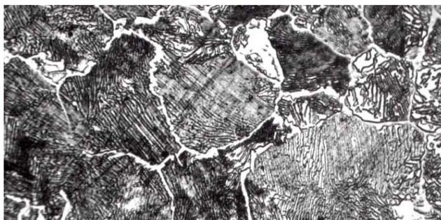
*Рис. 3.4. Микроструктура заэвтектоидной стали ( $\times 300$ )*
