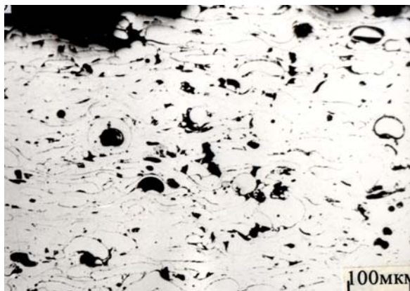
Рис. 2.13. Микроструктура газотермического покрытия из сплава на основе никеля ( \times 200 )
