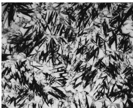
Рис. 4.23. Структура мартенсита закаленной стали 45
