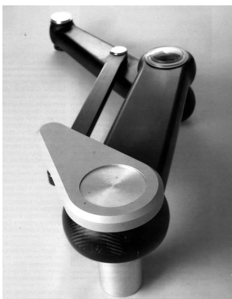
Рис. 5.15. Узел работа конвейерной линии, собранный из деталей УП-ВП
