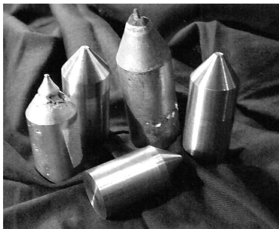
Рис. 4.14. Монокристаллы диаметром 30...35 мм, полученные в Сибирском физико-техническом институте, г. Томск
