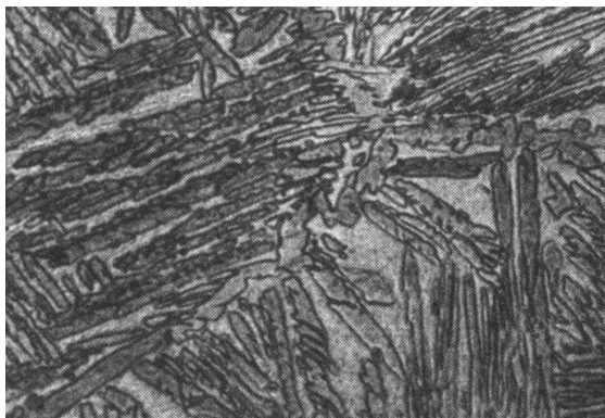
Рис. 3.10. Микроструктура титанового сплава ВТ6 после закалки ( \times 400 )
