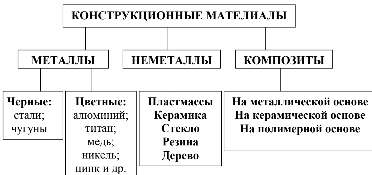
Рис. 1.1. Схема классификации конструкционных материалов
