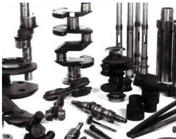
Рис. 4.27. Детали машин после закалки и высокого отпуска
