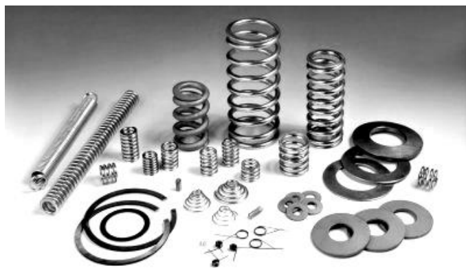
Рис. 4.26. Пружины и другие изделия с повышенной упругостью после закалки и среднего отпуска
