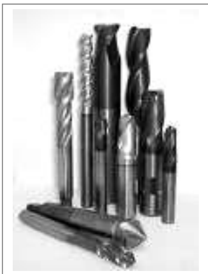
Рис. 4.25. Режущий инструмент после неполной закалки с низким отпуском
