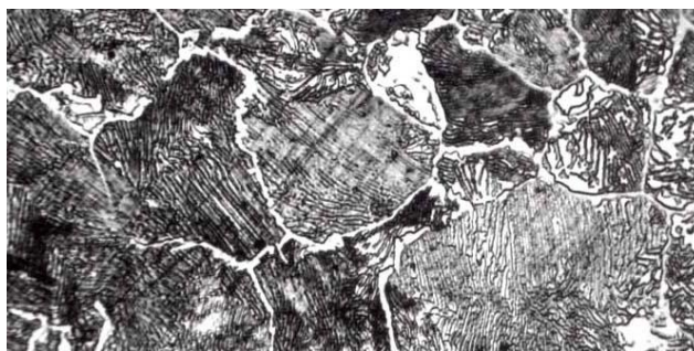
Рис. 3.4. Микроструктура заэвтектоидной стали ( \times 300 )
