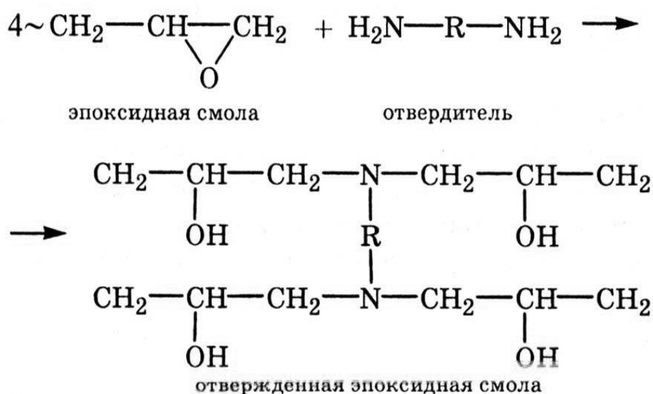
Рис. 5.3. Реакция отверждения эпоксидной смолы
