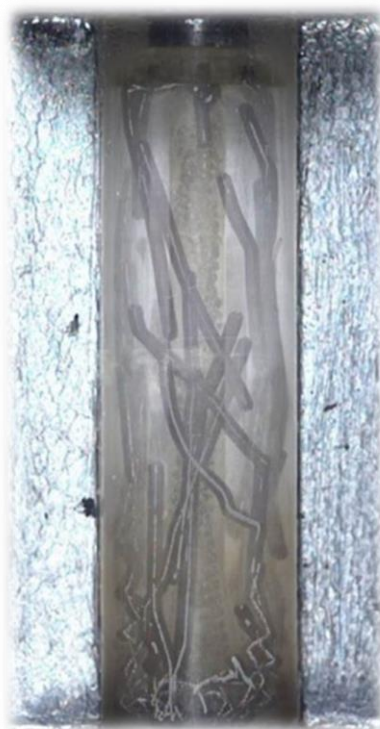
Рис. 54. Стробоскопическое изображение, иллюстрирующее траекторию движения шаров в затрубном пространстве
