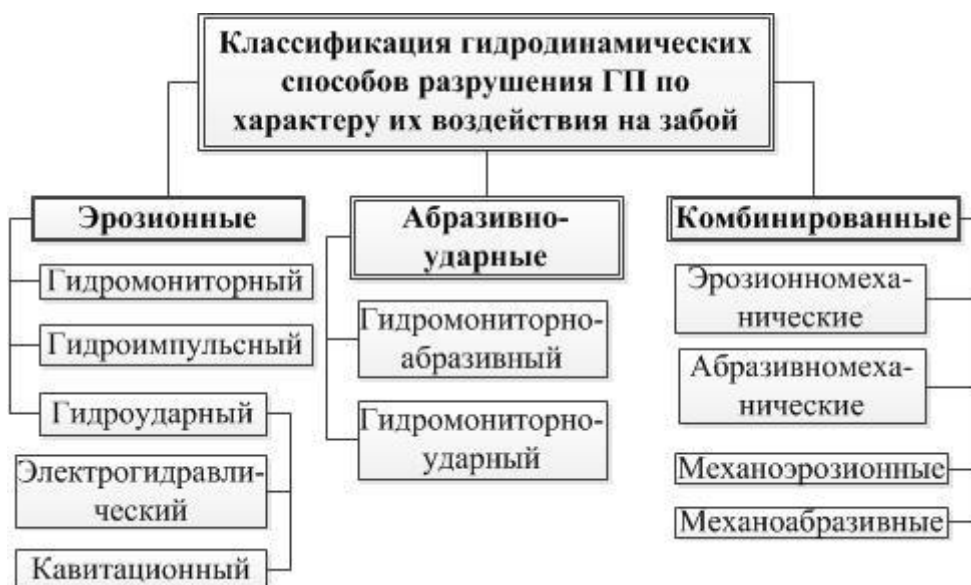
Рис. 1. Классификация гидродинамических способов разрушения горных пород по характеру силового воздействия на забой
