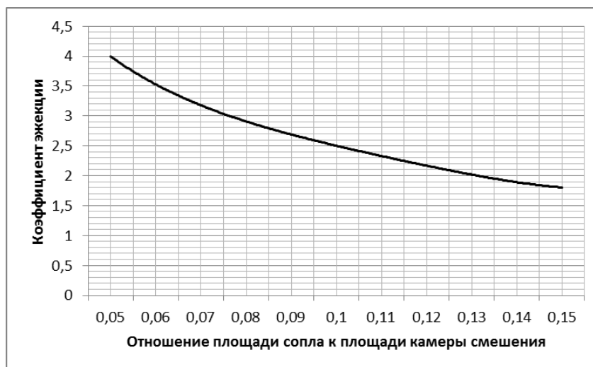
Рис. 16. Зависимость коэффициента эжекции от отношения площади сопла к площади камеры смешения [113]
