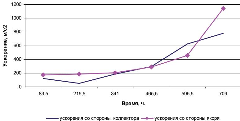
**Рис. 1.35.** Динамика изменения средних ускорений со стороны коллектора и якоря (вследствие износа подшипниковых узлов) электродвигателя в процессе ресурса
