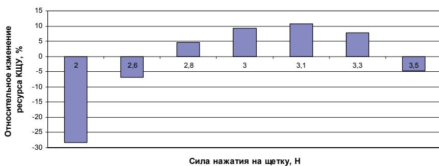
**Рис. 4.4.** Изменение ресурса КЩУ с постоянным нажатием в сравнении с базовым вариантом для электродвигателя LG VCE280E02
