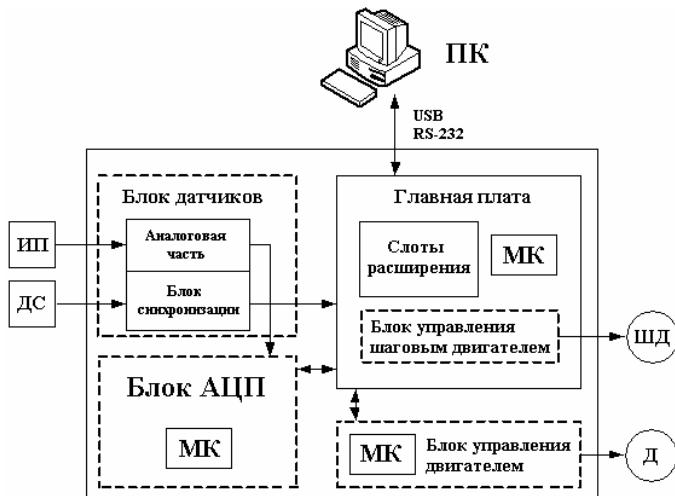
**Рис. 1.22.** Функциональная схема бесконтактного измерительного комплекса
