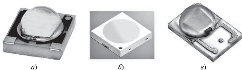
Рис. 5.12. Образцы светоизлучающих диодов:
