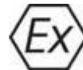
**2Ex** «светильниками повышенной надежности против взрыва» - предусмотрены меры защиты, затрудняющие образование опасных искр, дуг или перегрева только при нормальной работе светильников.
