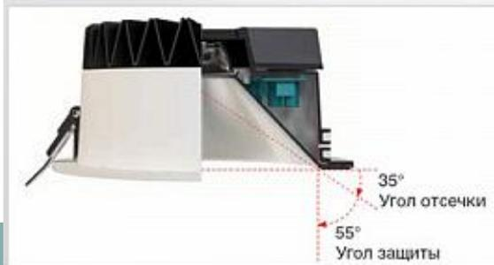
На расстоянии примерно 3 метров угол зрения человека может «совпасть» с углом рассеивания светильника и вызвать у человека слепящий эффект. Чтобы этого избежать, лучше выбирать модели с углубленным источником света и линзами Antiglare. У офисного и профессионального света угол отсечки должен быть 30-40°.
