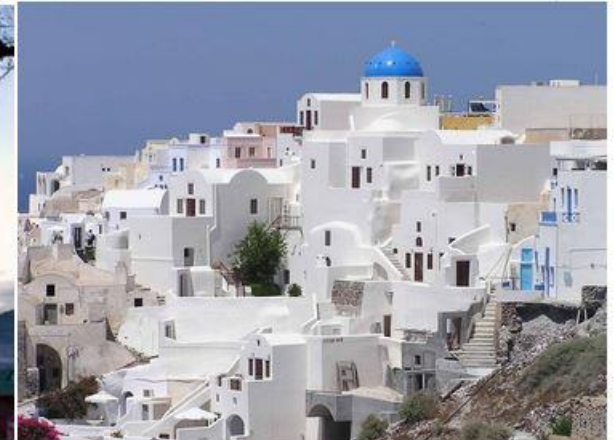
Архитектура районов с преобладающим количеством солнечных дней: маленькие окна, стены с высоким коэффициентом отражения
