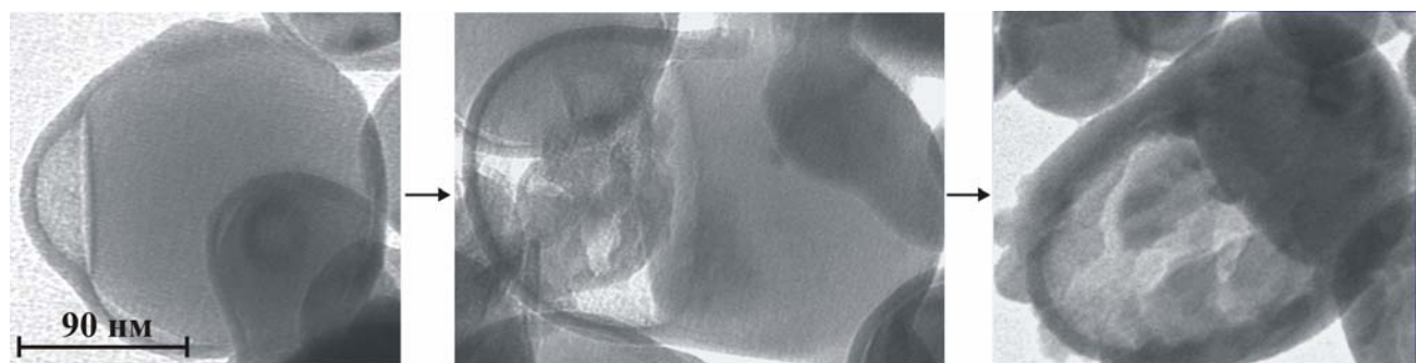
Рисунок 14 – Последовательность развития реакционной поверхности и роста зародышей фазы \gamma\text{-Al}_2\text{O}_3 в процессе окисления наночастиц Al в воздухе при 450^\circ\text{C}
