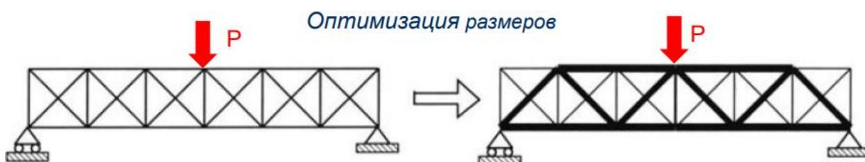
Рисунок 1.1 – Параметрическая оптимизация конструкции
