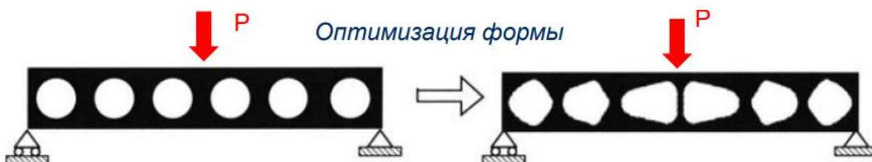
Рисунок 1.2 – Топологическая оптимизация конструкции
