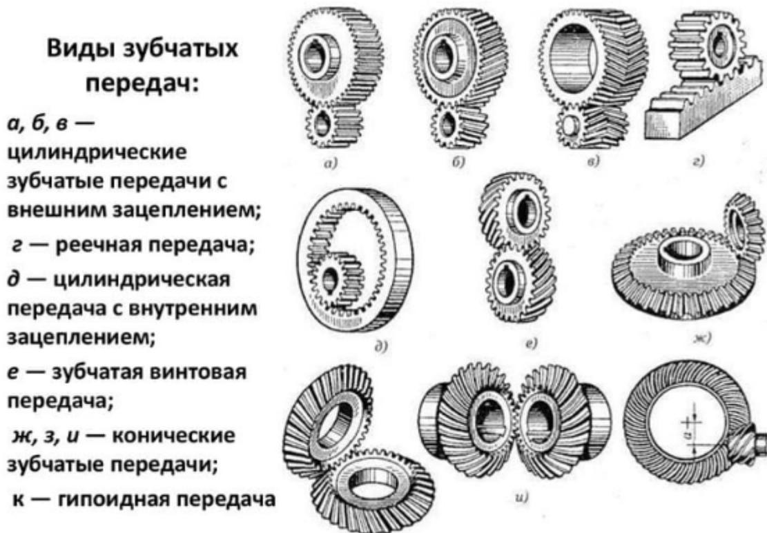
Рисунок 1 – Виды зубчатых передач
