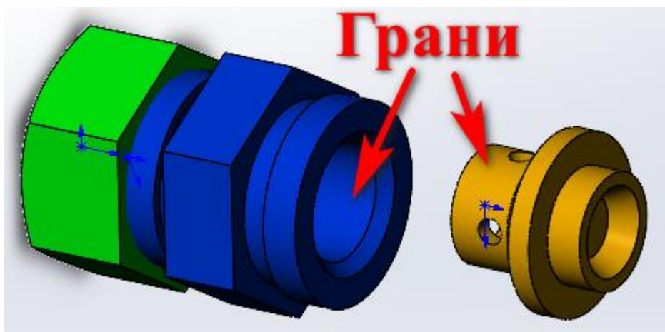
Рисунок 24 – Выбор граней для создания сопряжения «Концентричность» Создайте сопряжение «Совпадение» между наклонными гранями, рисунок 25.
