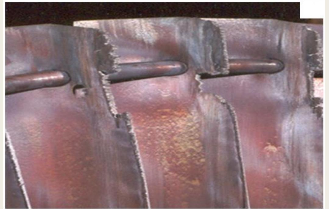
Характерный вид **отложений** на лопатках паровых турбин
