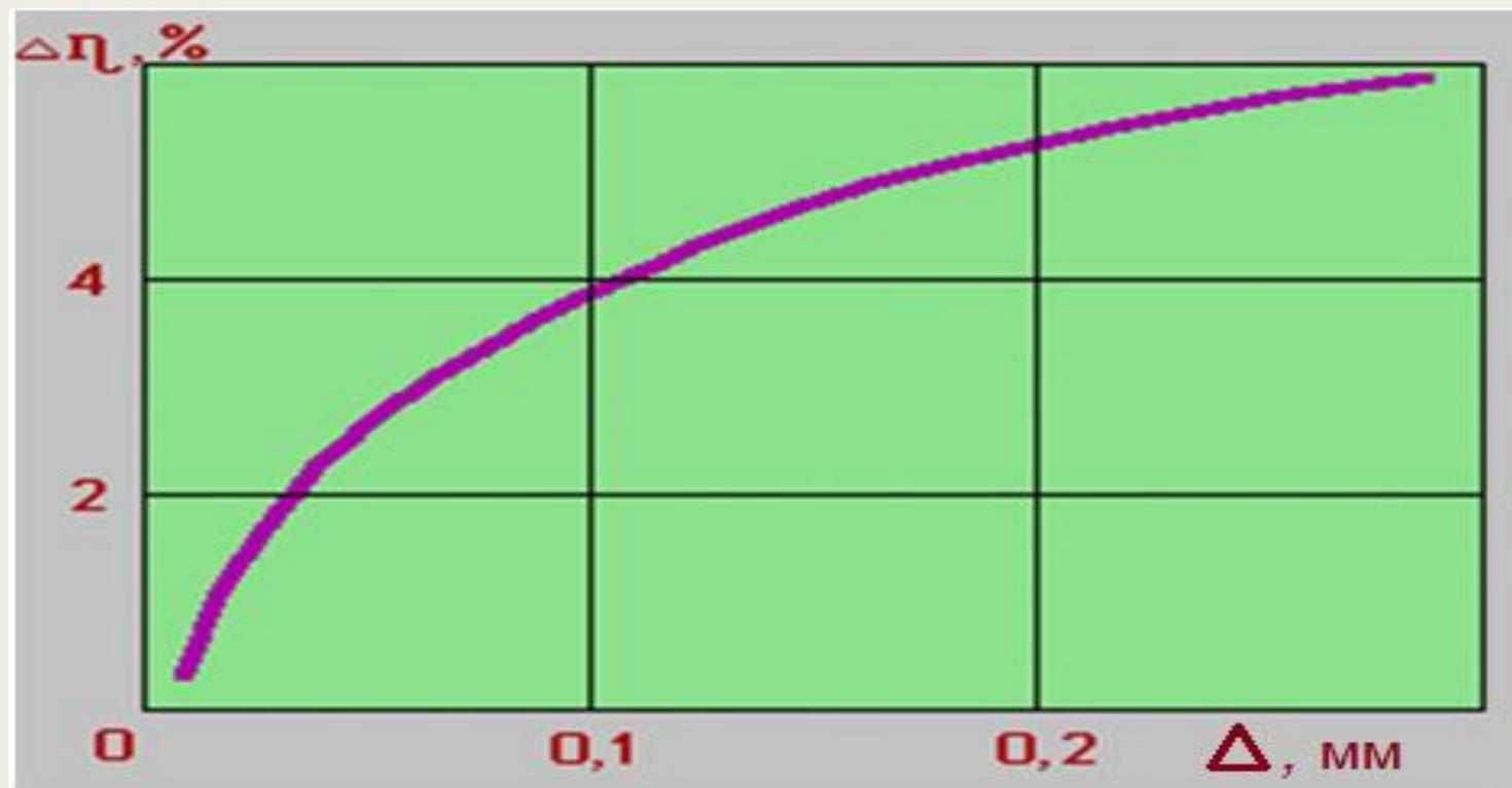
Снижение КПД турбинной ступени с ростом шероховатости
