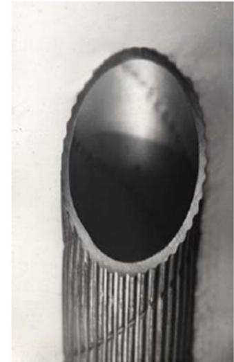
Рис. Трубки с продольными ребрами
