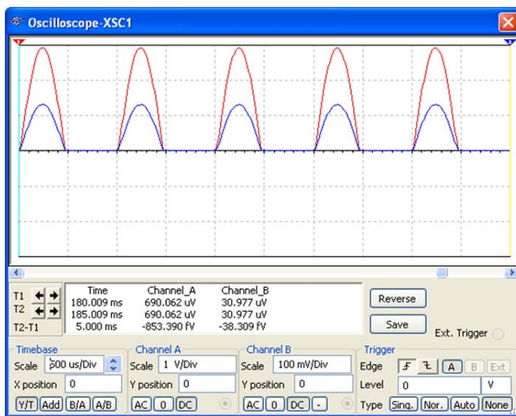
Рис. 4.45. Временные диаграммы выходного напряжения и тока диода выпрямителя
