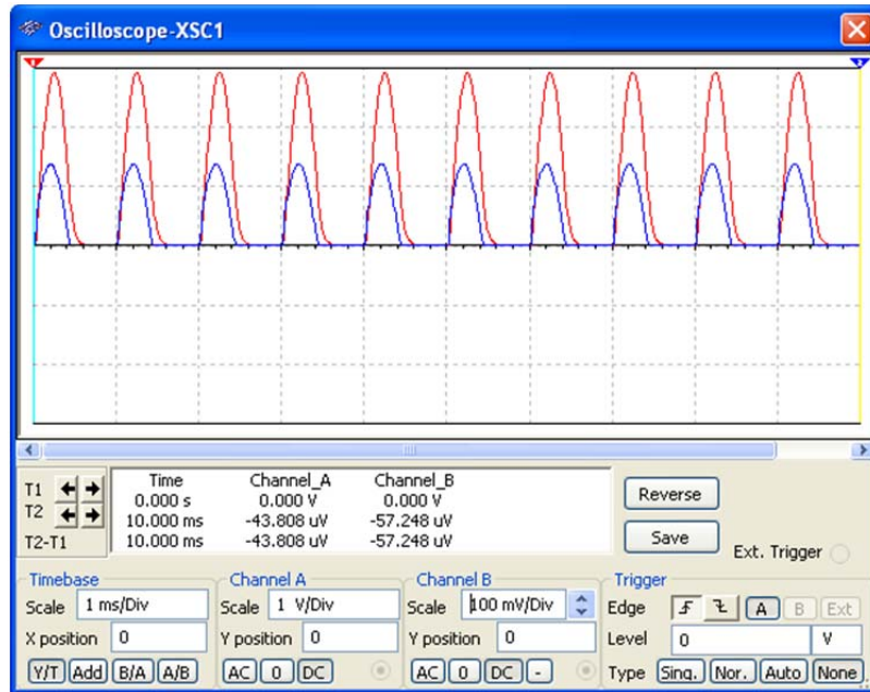
Рис. 4.47. Временные диаграммы выходного напряжения и тока диода выпрямителя
