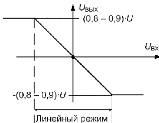
Рис. 3.58. Типичный вид амплитудной характеристики инвертирующего включения ОУ для двухполярного и симметричного питания
