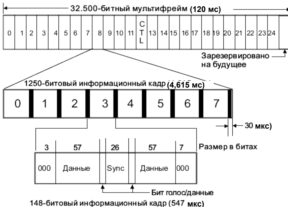
Рис. 74. Структура кадров в GSM
