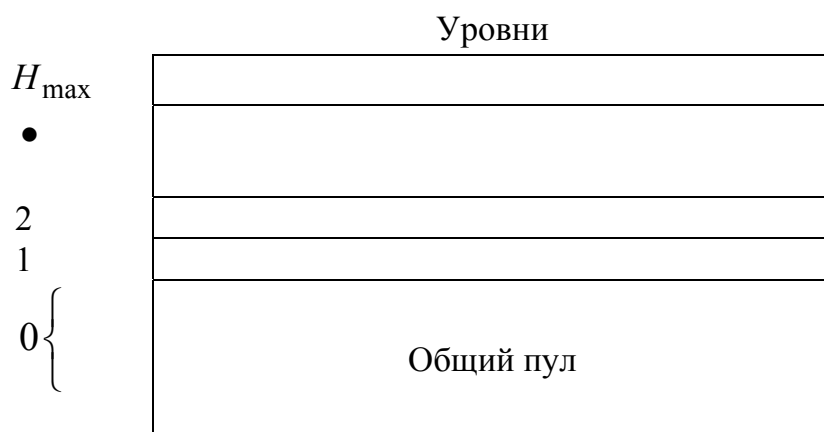
Рис. 16. Структурированный буферный пул
