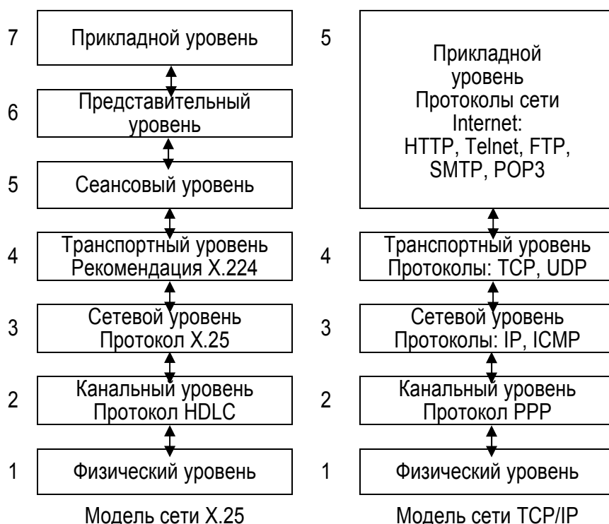
Рис. 44. Модели сетей X.25 и TCP/IP
