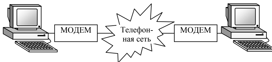
Рис. 41. Схема соединения компьютеров через телефонную сеть
