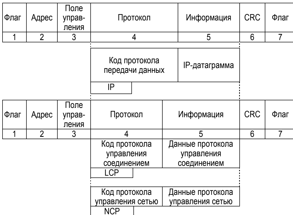
Рис. 45. Структура кадра протокола PPP
