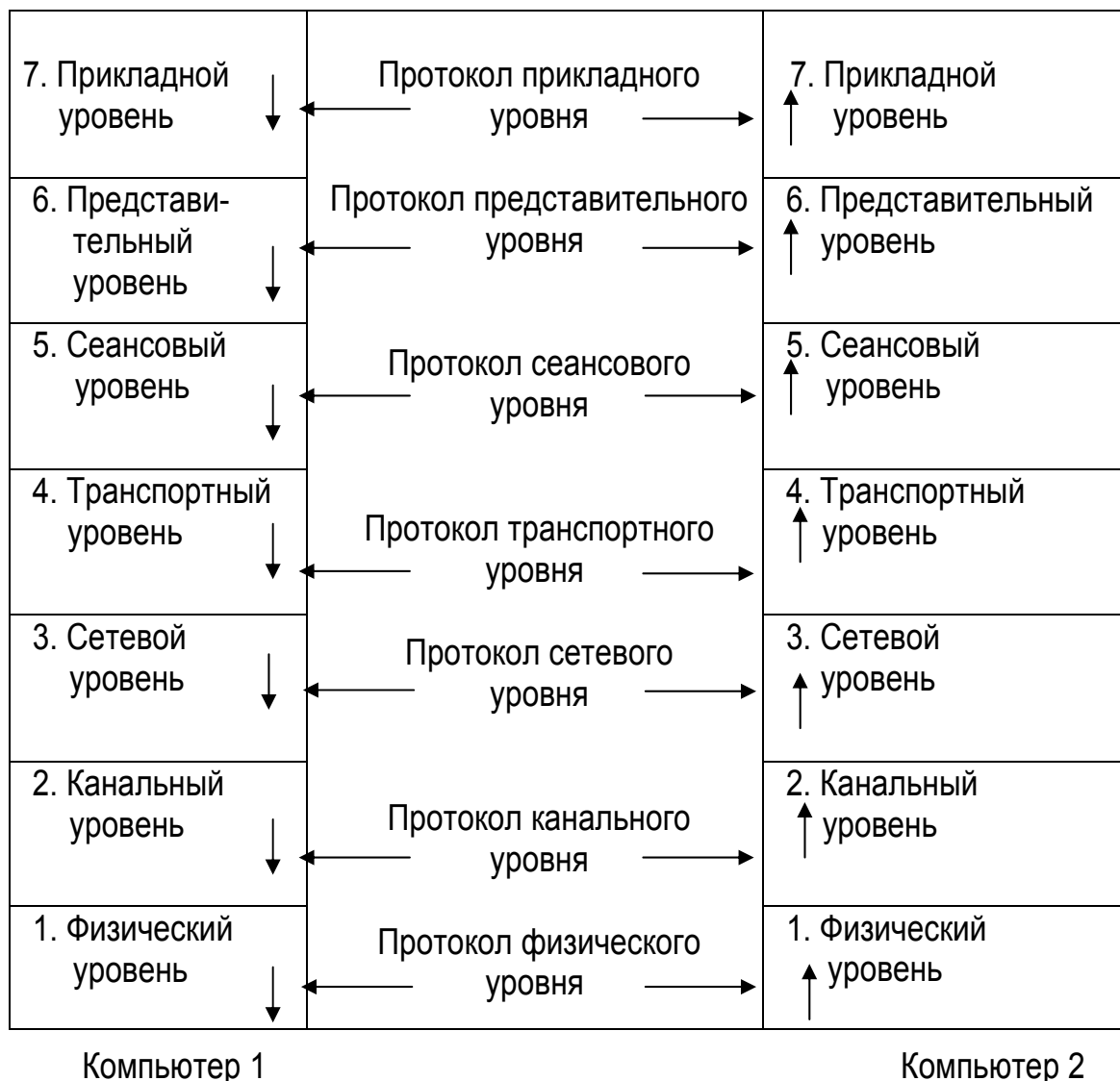
Рис. 17. Схема взаимодействия протоколов компьютерной сети модели ISO/OSI
