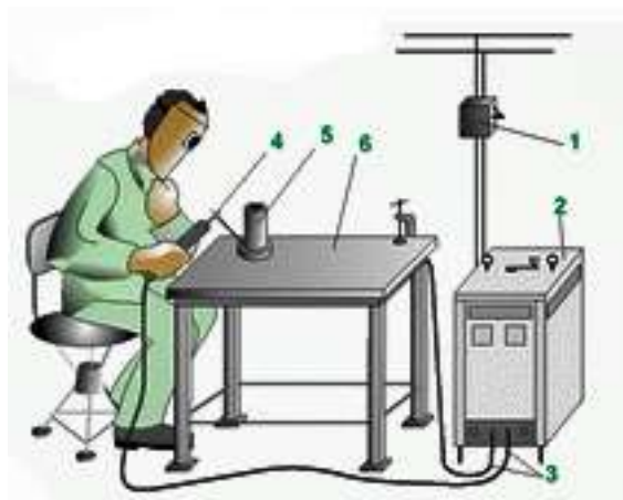
Рис. 27. Пост для ручной дуговой сварки 1 – выключатель; 2 – источник питания; 3 – сварочные провода; 4 – электрододержатель; 5 – свариваемое изделие; 6 – стол
