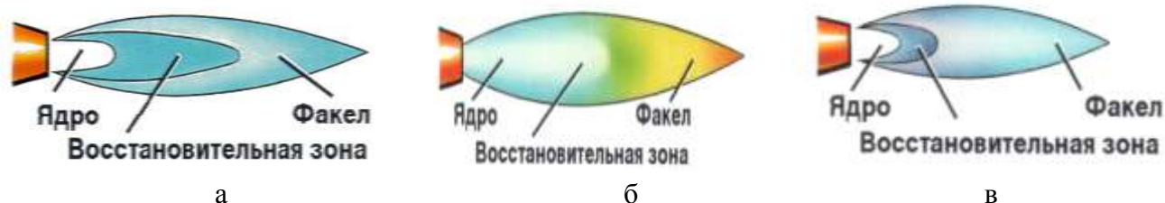
Рис. 42. Строение ацетиленокислородного пламени: а–нормальное, б–науглероживающее, в– окислительное
