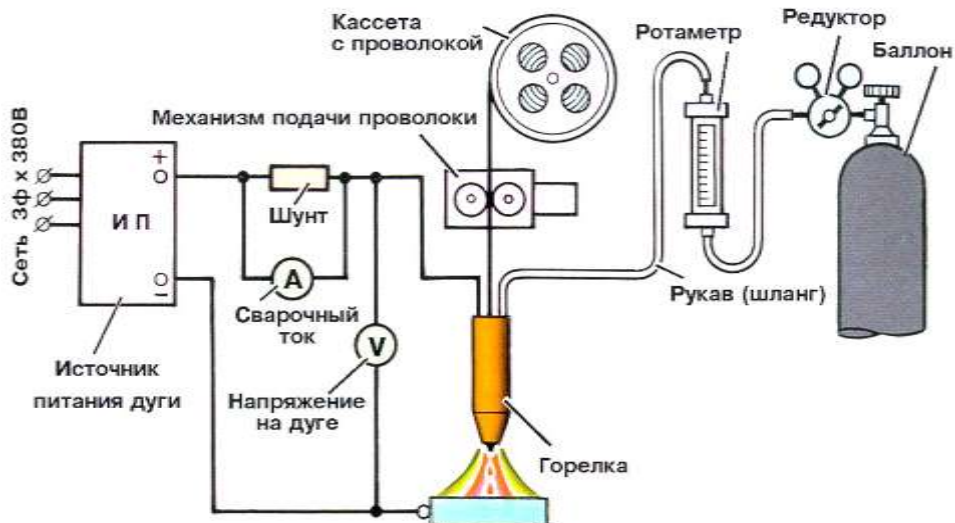
Рис. 25. Пост для сварки в углекислом газе
