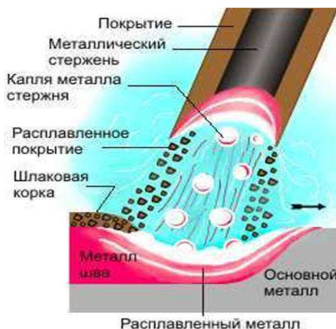
Рис. 13. Схема процесса ручной дуговой сварки покрытыми электродами
