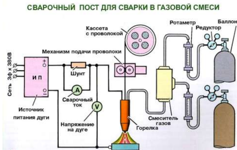
Рис. 40. Сварочный пост для сварки в газовой смеси
