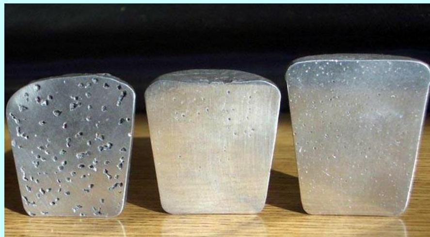
**Неметаллические включения** — химические соединения Me с неMe, находящиеся в сталях и сплавах в виде отдельных фаз.
