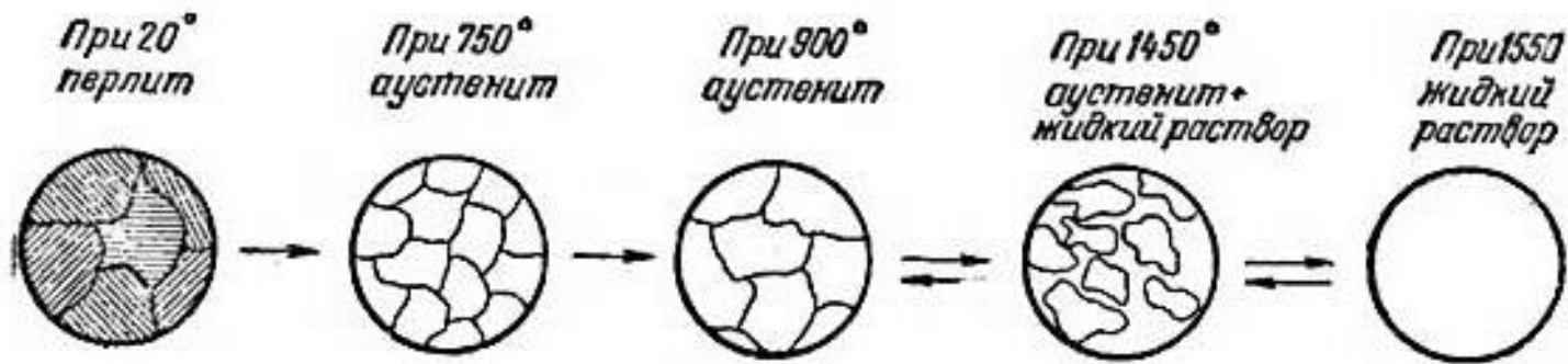
Схема структурных превращений стали (0,8%С) при нагреве
