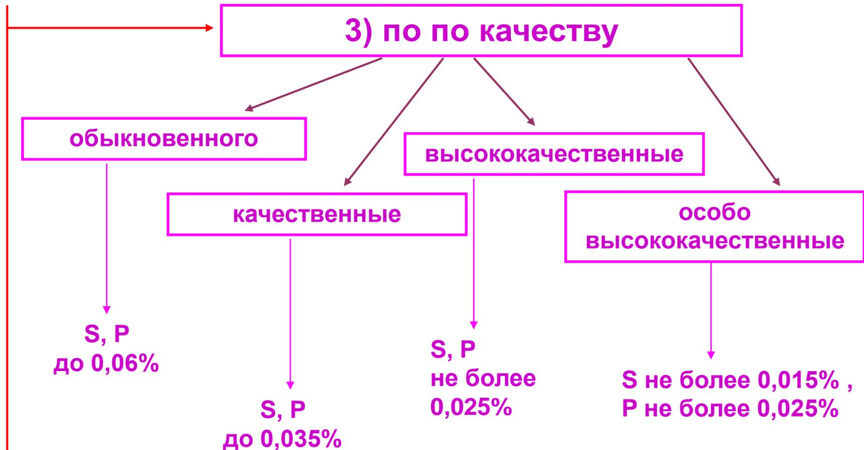
Под **качеством** понимается совокупность свойств стали, определяемых металлургическим процессом ее производства, зависят от содержания вредных примесей и газов (O,N,H). Основными показателями для разделения сталей по качеству являются нормы содержания вредных примесей (S, P).
