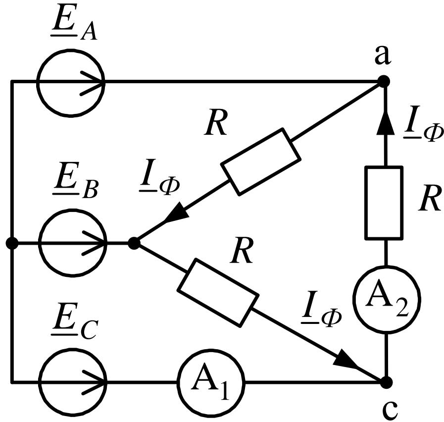
В симметричной трёхфазной цепи фазное напряжение генератора 127 В, сопротивление фаз нагрузки  $R=11$  Ом.
