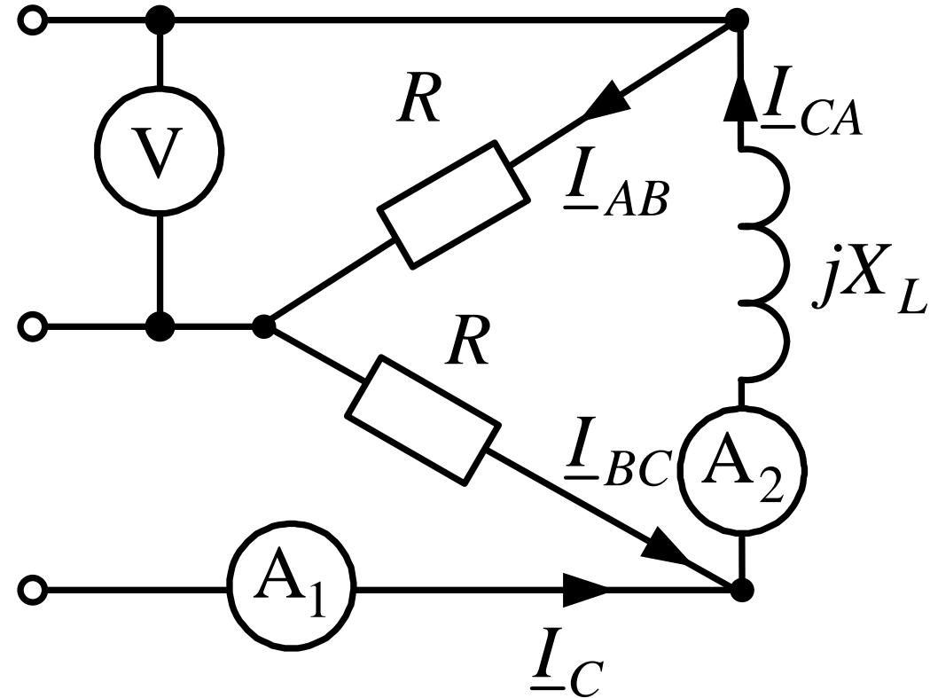
В несимметричной трёхфазной цепи напряжение вольтметра 220 В, сопротивление фаз нагрузки  $R=X_L= 11 \text{ Ом}$ .
