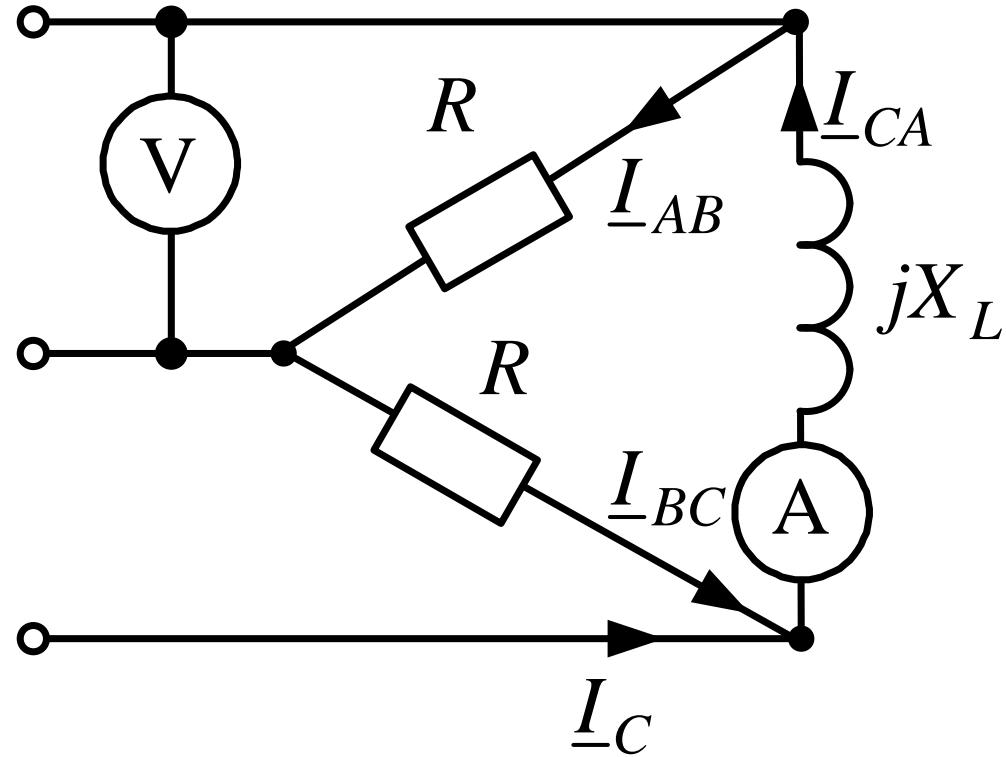
В несимметричной трёхфазной цепи, сопротивление фаз нагрузки  $R=X_L=11$  Ом, Показания амперметра 38,62 А.
