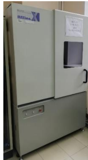
Дифракционный комплекс с возможностью проведения in situ исследований в процессах нагрева и в агрессивных средах
