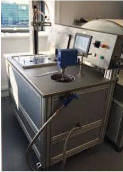
Бумагоделательная машина Dynamic HandSheet Former.
