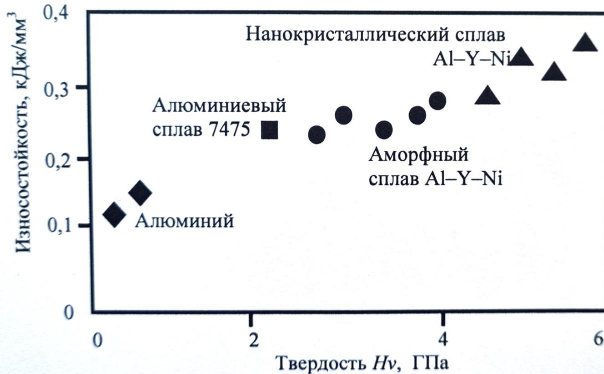
Рис. 21.28. Соотношение между износостойкостью и твердостью алюминиевых сплавов
