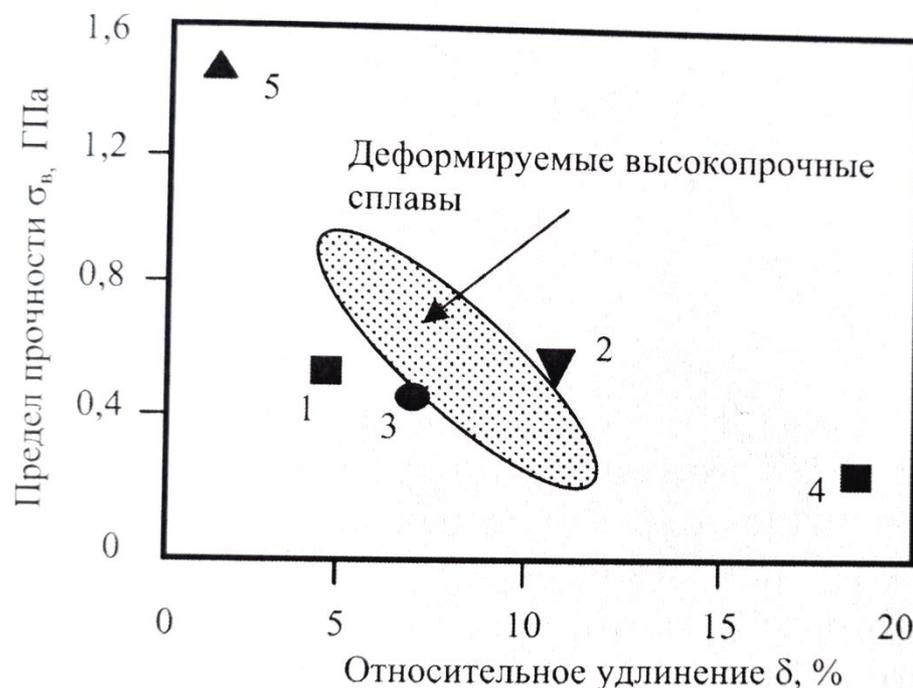
Рис. 21.29. Соотношения между прочностью и пластичностью для различных алюминиевых сплавов:
