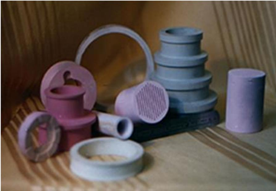
Конструкционная нанокерамика применяется для изготовления ножей и фильер для переработки пластмасс, резки химических волокон, изготовления лезвий бытовых ножниц и медицинских скальпелей; фильер протяжки проволоки, форсунок распылительных камер; втулок клапанов, различного рода уплотнений и др. Керамические материалы обладают высокой стойкостью в химических растворах. Востребованные на рынке продукты:
