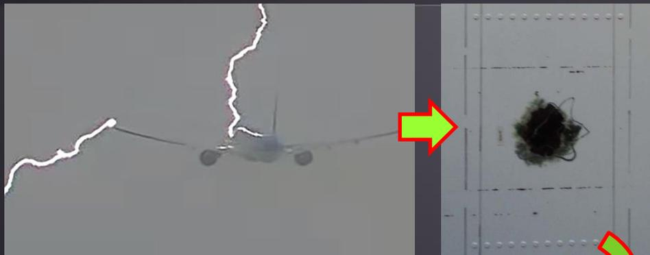
В месте электрического пробоя высоковольтный разряд приводит к серьезному повреждению
