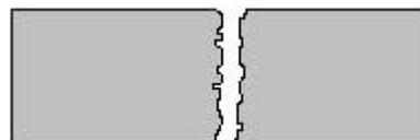
Рис. 4.2. Схема соприкосновения двух металлических поверхностей
