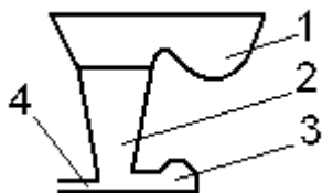
Рис. 7. Литниковая система: 1 – литниковая чаша; 2 – стояк; 3 – шлакоуловитель; 4 – питатель
