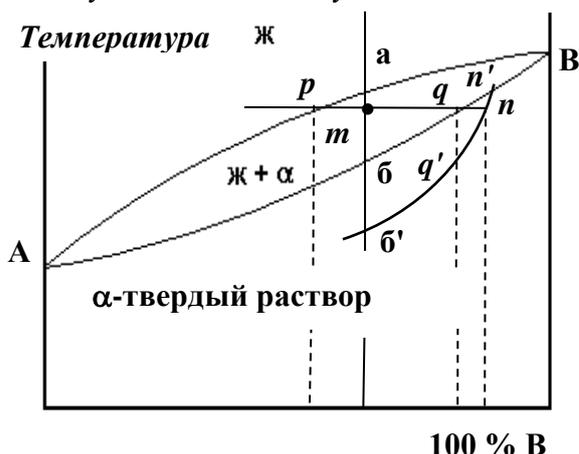
Рис. 2.6. Диаграмма состояния сплавов с полной растворимостью компонентов
