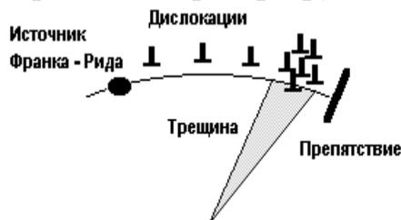
Рис. 1.22. Образование трещины при скоплении дислокаций у препятствия
