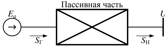
Рис. 1.5. Обобщенная схема замещения одномашинной энергосистемы
